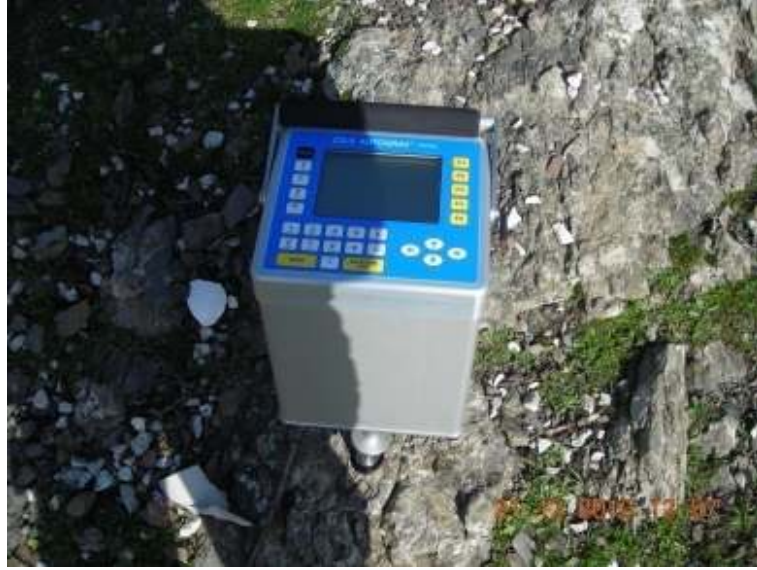
Şekil 5.2 Scintrex CG-5 Autograv cihazının arazi kullanımı.
