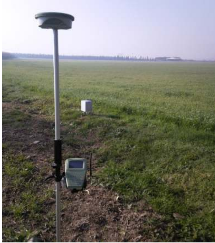
Şekil 5.3 Leica 1200+GPS cihazı mikrogravite ölçümü sırasında.
