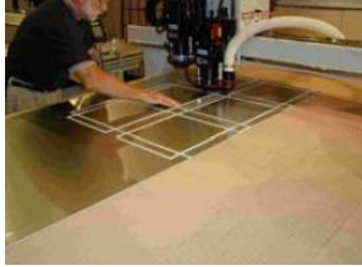
Şekil 3.10 Paslanmaz çelik kompozit malzeme üretimi(Alpolic, 2012)
