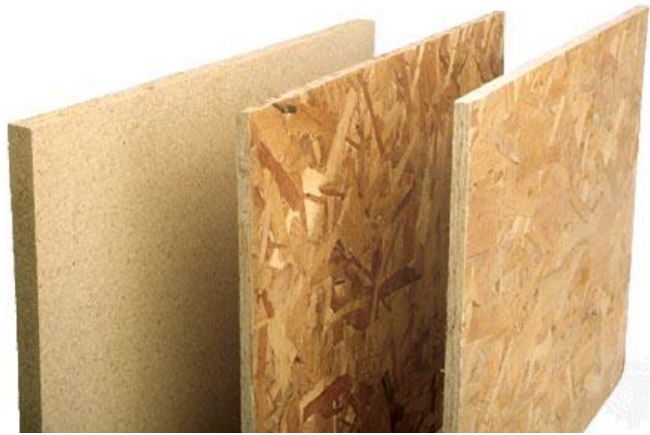
Şekil 3.46 Soldan sağa, Yonga levha (PB), Waferboard, OSB (Britannica, 2012)
