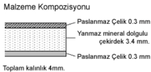
Şekil 3.12 Paslanmaz çelik kompozit panel kesiti (Alpolic, 2012)
