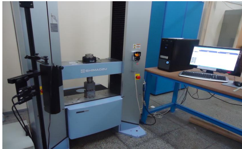
Şekil 4.10 Basma mukavemetinin deneysel olarak belirlenmesi
