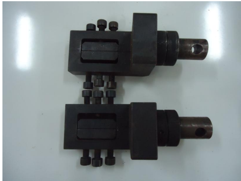
Şekil 4.13 Kayma testleri sırasında kullanılan aparat
