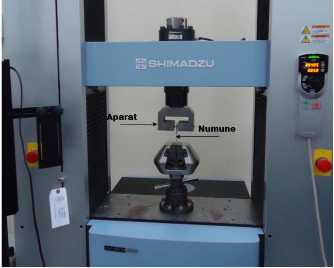
Şekil 4.16 Pim bağlantılı çekme deneyi
