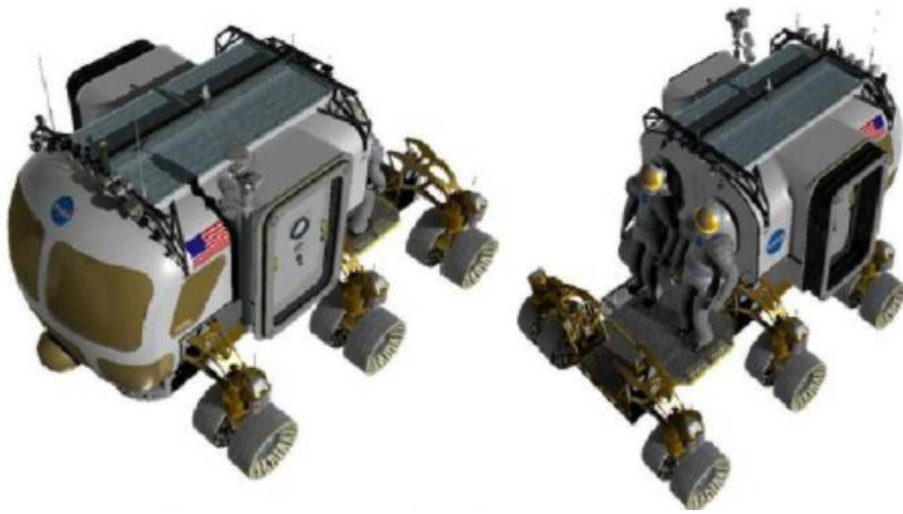
Şekil 4.7 LER hareketli sistem konsepti (Kennedy, Toups , Rudisi ve LSS Habiatat Ekibi, 20
