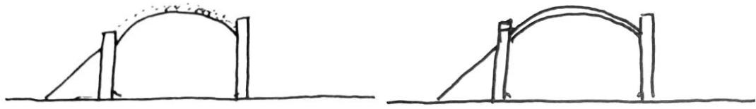
Şekil 4.35 Çatının regolit ile kaplanması (Rousek, Eriksson ve Doule, 2012)
