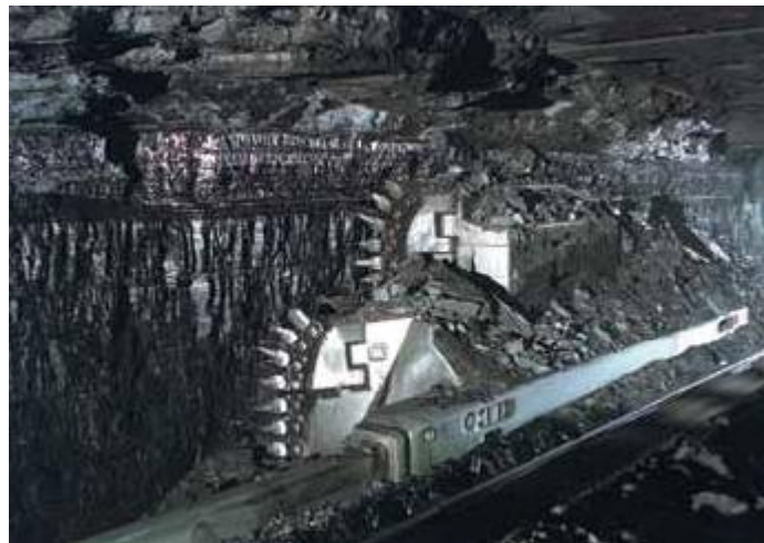
Şekil 2.1 Kazı arınındaki direksiz cephe
