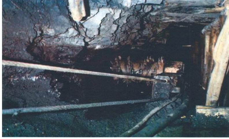
Şekil 2.16 İnce kömür damarlarında kullanılan tamburlu kesici makine
