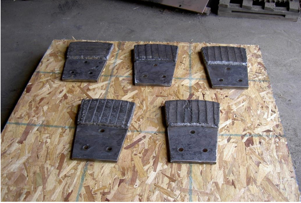
Şekil 4.2 Aşınmaya maruz kalan öğütücü pedallar
