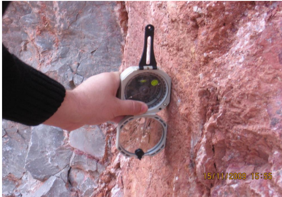
Şekil 6.7 Uygulama sahasında pusulanın tabaka yüzeyinden kullanımı.
