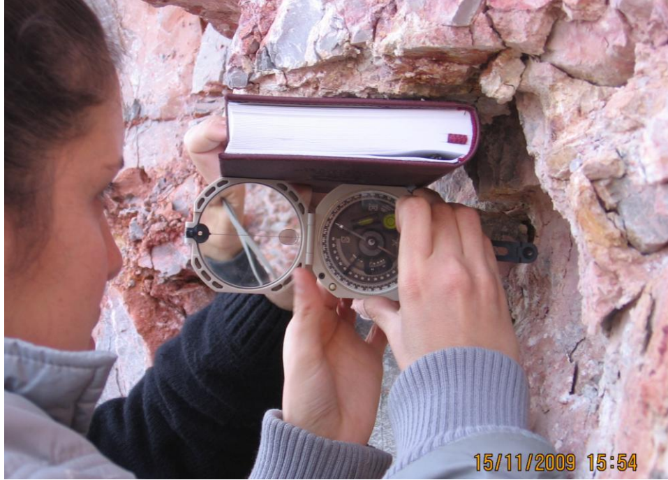
Şekil 6.6 Uygulama sahasında pusulanın tabaka altından kullanımı.
