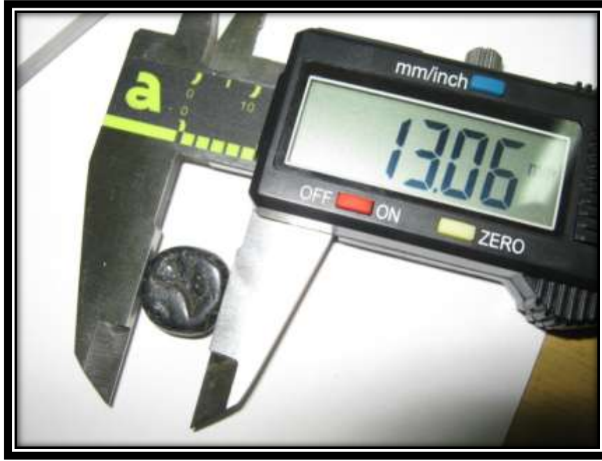
Şekil 2.2 Müzedeki antik süstaşı ürünlerin envanterlemesi için boyutlarının tespit edildiği dijital kumpas. Malzemenin; eni, boyu, yüksekliği, iç ve dış çap ölçümleri milimetre ve inch cinsinden hassas olarak yapılabilmektedir.
