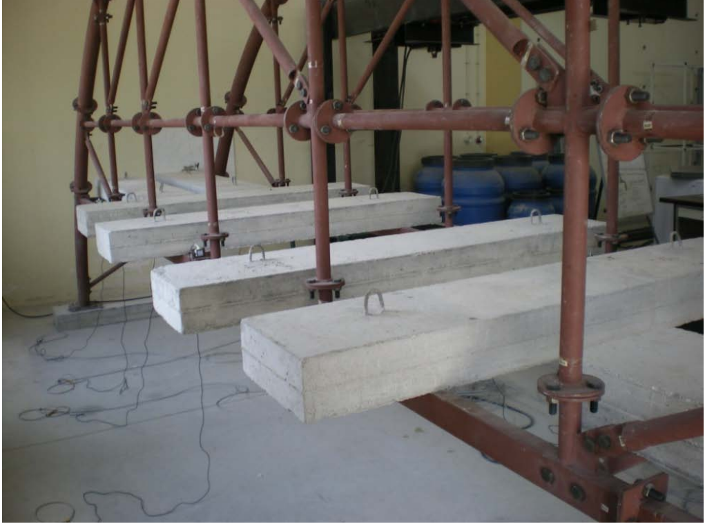
Şekil 8.17 Köprü üzerindeki betonarme ağırlıklar.
