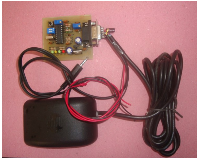
Şekil 4.13 GPS' in Tiny Tracker devresine bağlantısı
