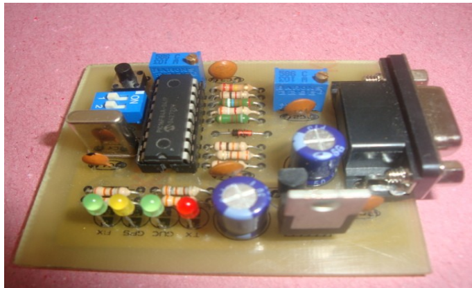
Şekil 4.11 TCM 3105 kullanılan devre (Mobil APRS ve Tinytrak)
