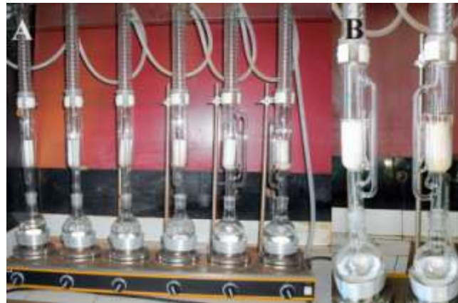
Şekil 2.7 A. Soxhlet cihazı, B. Thimble içine yerleştirilmiş midye örneği.
