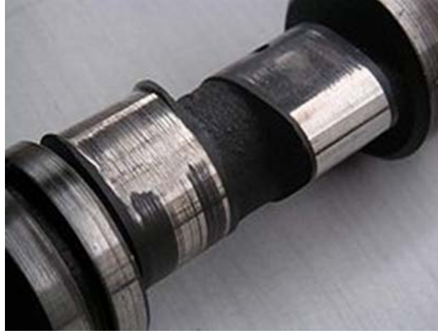
Şekil 4.1 Kam mili üzerinde zamanla oluşmuş adezyon aşınması (Adezyon_aşınması, 2013).
