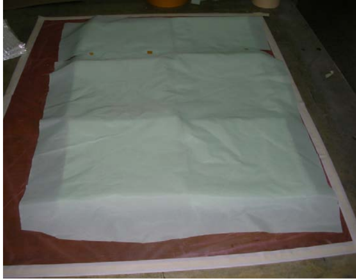
Şekil 5.9 İstiflenen elyafın üzerine reçinenin vakum torbasına yapışmasını önleyen soyma kumaşının (peel ply) serilmesi.
