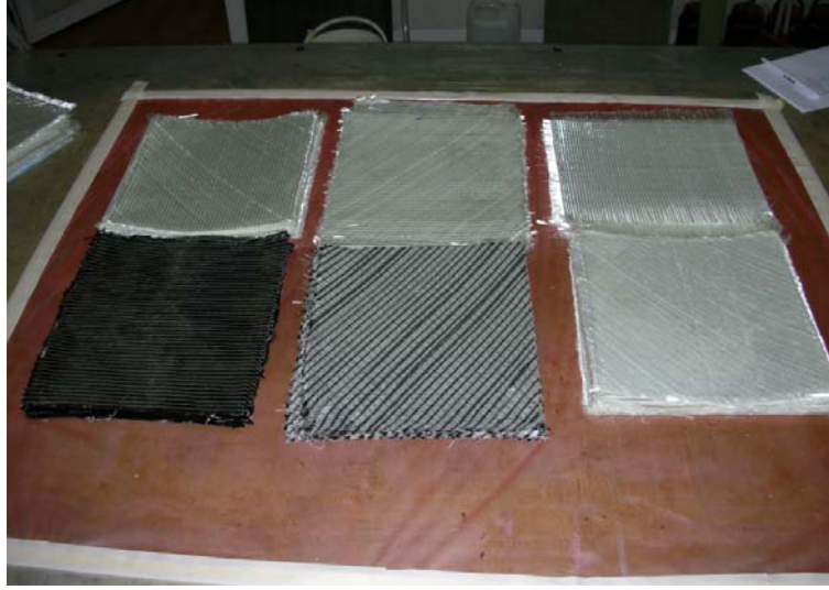
Şekil 5.8 Ayrılcı filmin üzerine önceden kesilip katlanan, altı farklı tip elyafın yeterli kalınlığa ulaşmaya kadar istiflenmesi.
