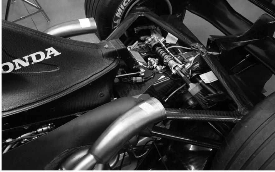
Şekil 2.19 Formula 1 yarışa arabalarındaki karbon elyaf takviyeli epoksi süspansiyon ve vites kutusu (Mallick, 2008).
