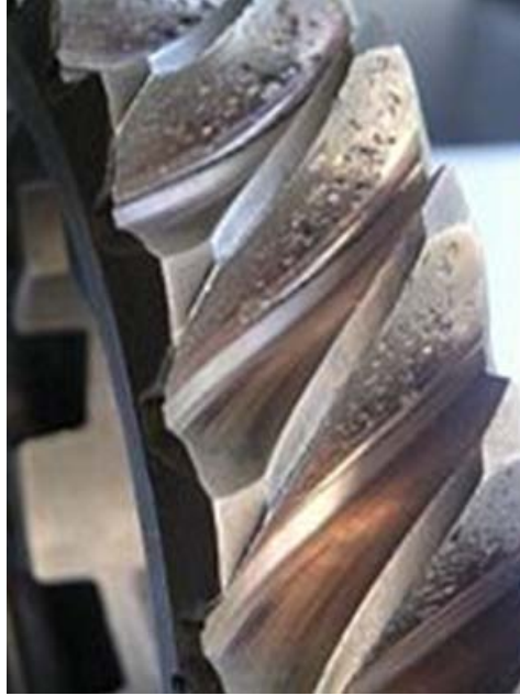
Şekil 4.3 Sonsuz vida karşılık dişlisinde yorulma aşınması (Triboloji, 2013).
