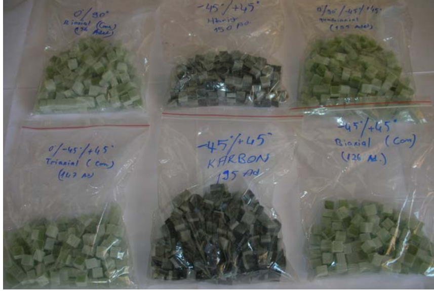
řekil 5.17 retilen tm kompozit malzemelerin 12,7x12,7x12,7 mm kpler řeklide kesilmesi ve torbalara ayrılması.
