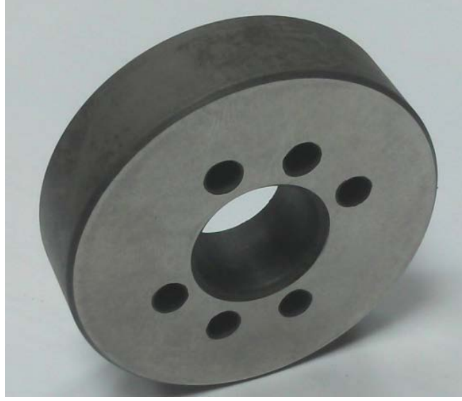
Şekil 5.19 AISI 52100 malzemeden imal edilen 65 HRC sertliğe sahip aşındırıcı disk.
