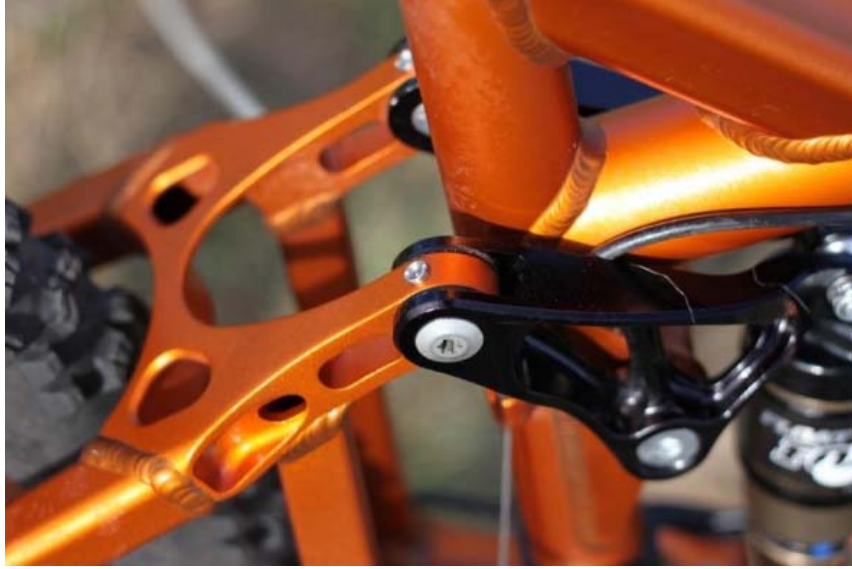
Şekil 2.24 Bisiklette kullanılan kompozit kaymalı yatak uygulaması (turnerbikes, 2013)
