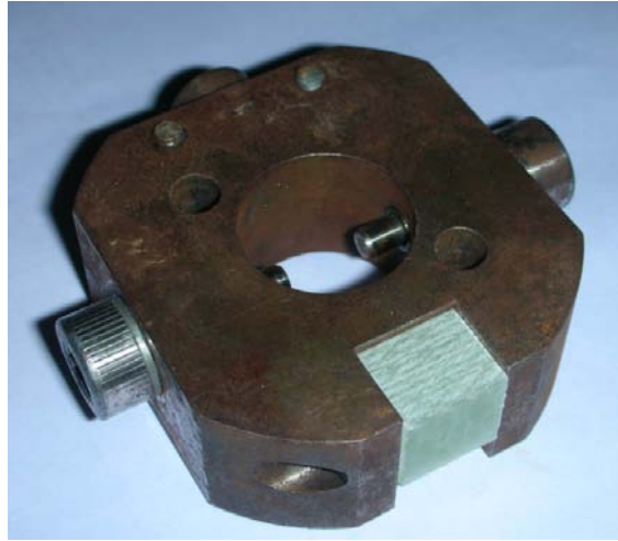
Şekil 5.2 TE53 Çok amaçlı sürtünme aşınma test cihazının numune bağlama aparatı ve üzerine bağlanmış numune.
