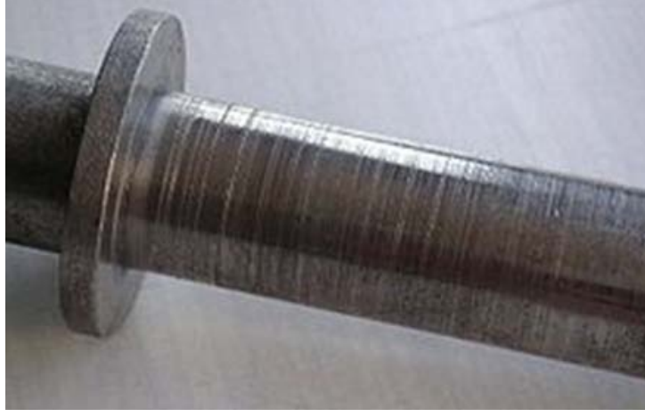
Şekil 4.2 Mil üzerinde zamanla oluşmuş adezyon aşınması (Abrazyon_aşınması, 2013).
