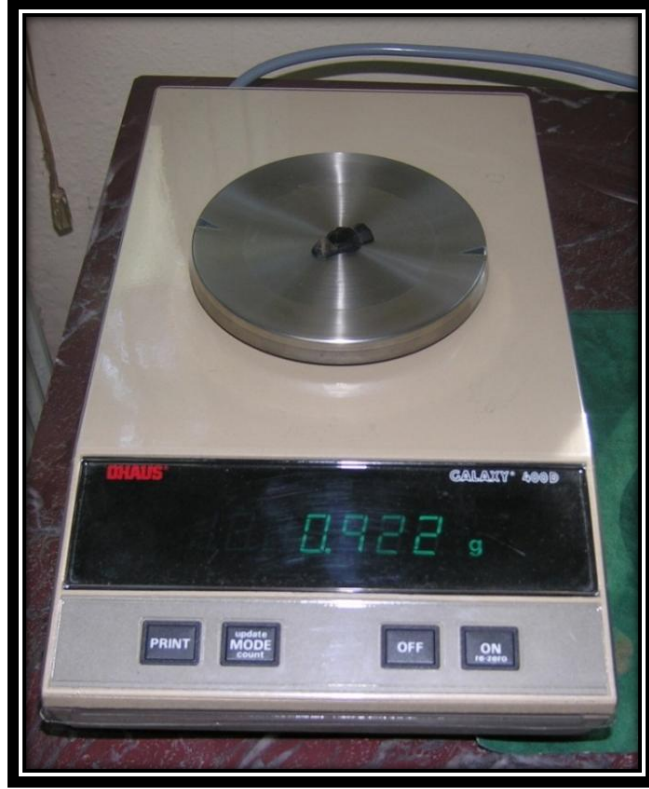
Şekil 2.1 Müzedeki antik süstaşı ürünlerin envanterlemesi için ağırlıklarının tespit edildiği dijital terazi.
