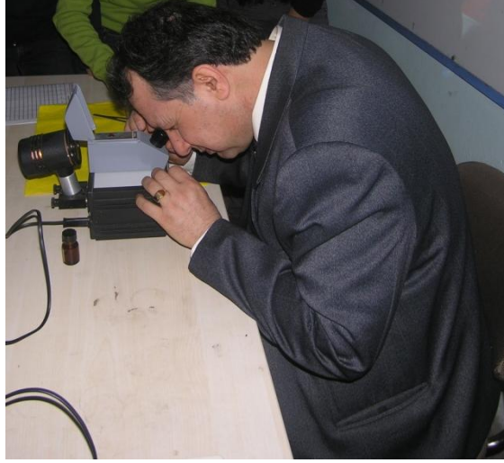
Şekil 2.5 Standart refraktometre cihazı kullanarak antik süstaşı ürünlerinin incelenmesi.
