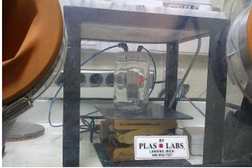
Şekil 2.4 Mikrogram düzeyinde tartım yapan hassas terazi kullanılarak koku salımı ölçümü deney düzeneği 2. resim
