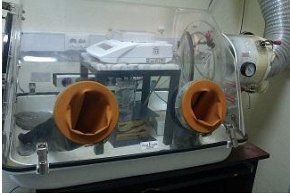
Şekil 2.3 Mikrogram düzeyinde tartım yapan hassas terazi kullanılarak koku salımı ölçümü deney düzeneği 1. resim
