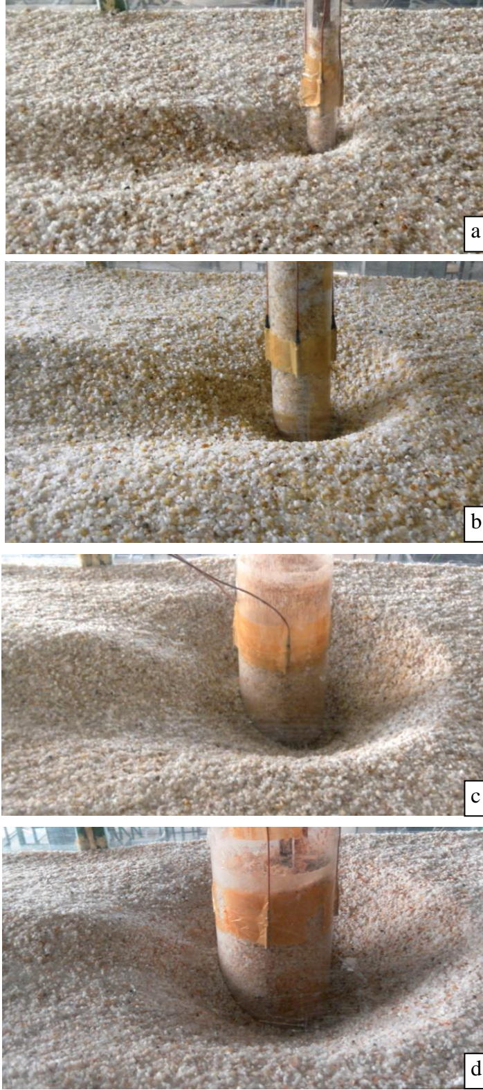
Şekil 3.13 a) 4 cm, b) 8 cm, c) 15 cm, d) 20 cm çapındaki köprü ayağı etrafında meydana gelen oyulmalar
