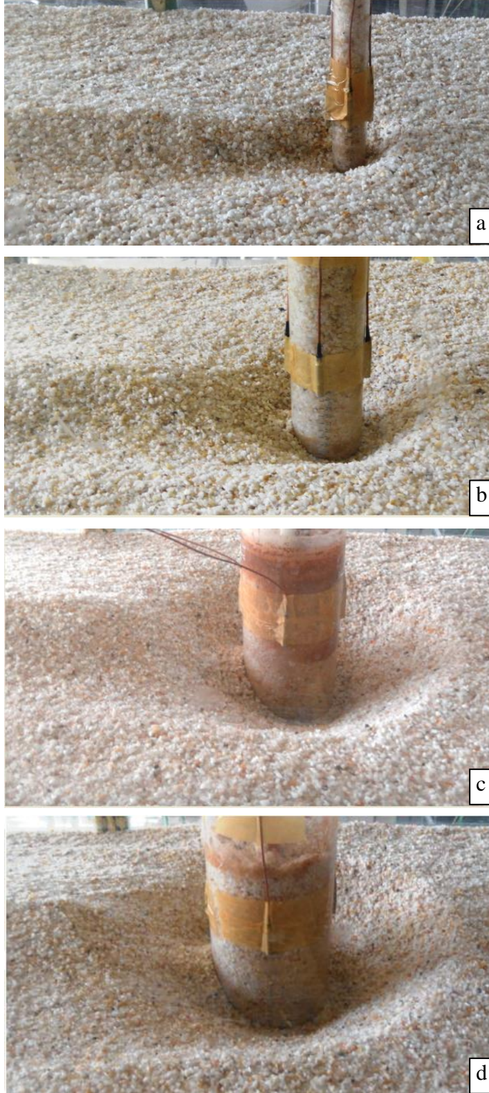
Şekil 3.11 a) 4 cm, b) 8 cm, c) 15 cm, d) 20 cm çapındaki köprü ayağı etrafında meydana gelen oyulmalar
