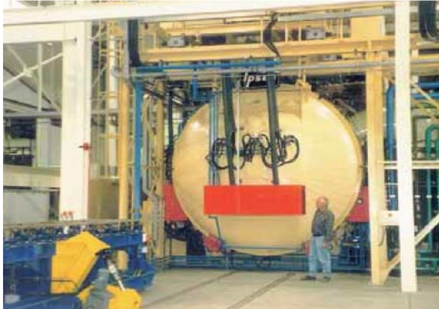
Şekil 3.7 Sert lehimleme için yığın vakum fırını. Ağır parçalar için fırının yukarısındaki raylar kullanılır. (Anderssonvedg., 2011)
