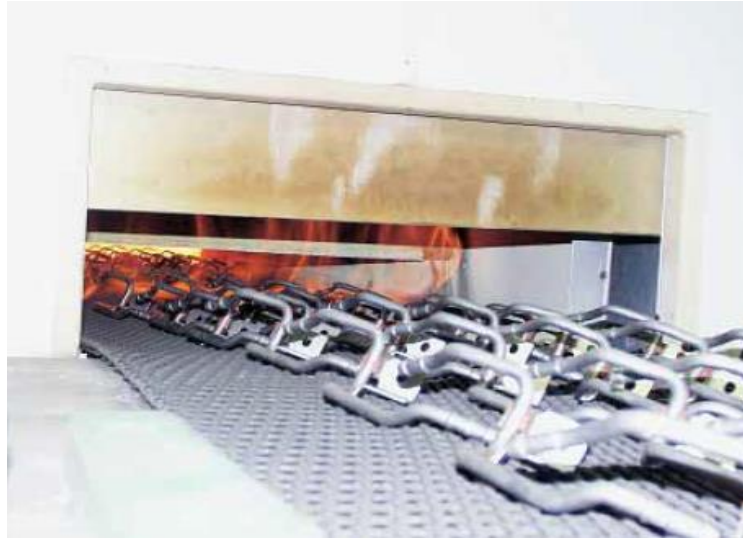
Şekil 3.1 örgülü bir tel üzerinde sürekli bir atmosfere giren parçalar (Andersson ve dg., 2011)
