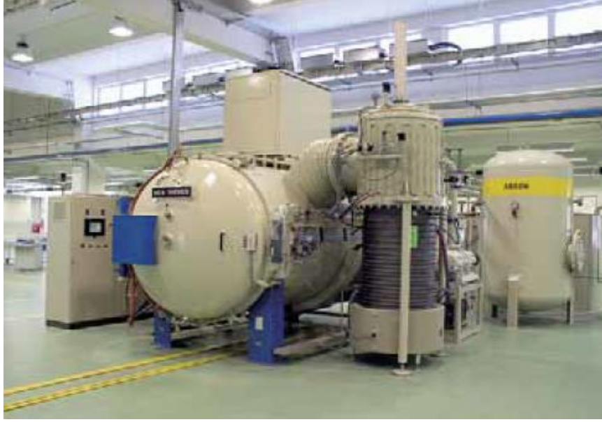
Şekil 3.6 Sert lehimleme için solda yığın vakum fırını, sağda Argon mahzeni görünmektedir. (Andersson ve dg., 2011)
