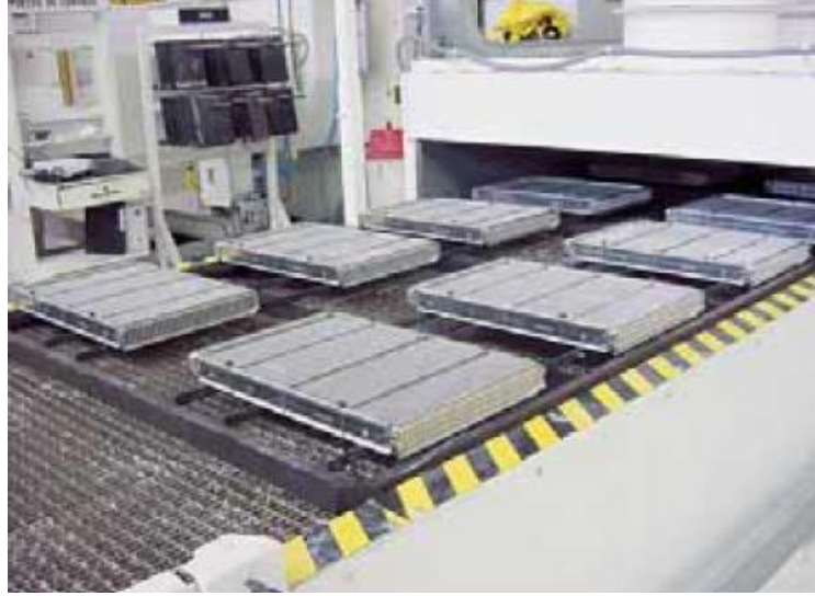
Şekil 4.2 Alüminyum ısı dönüştürücülerin kontrollü azot atmosferine girişi. (Andersson ve dg., 2011)
