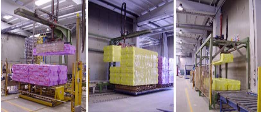
Şekil 3.18 Mermer işleme tesisinde ağaç dışı ambalajlama
