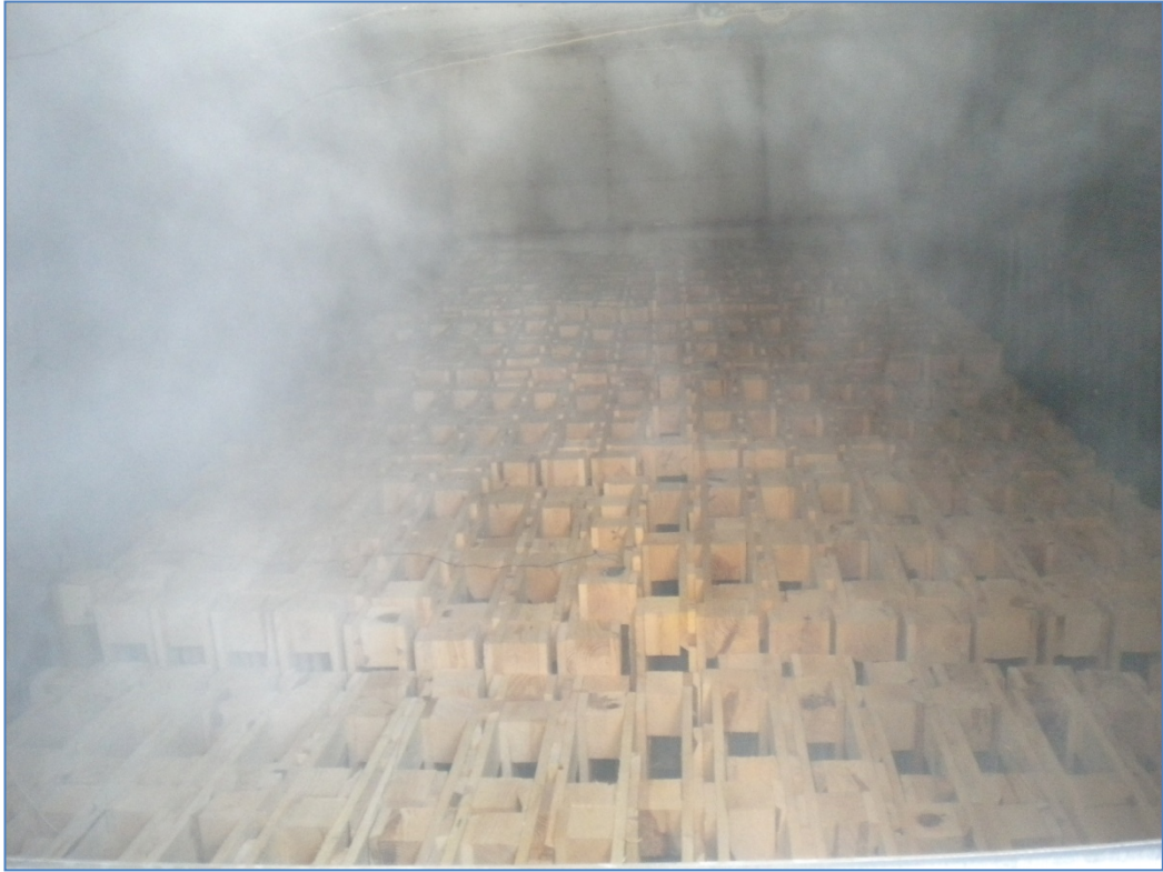
Şekil 6.8 Isıl işlem sırasında fırın içindeki paletler
