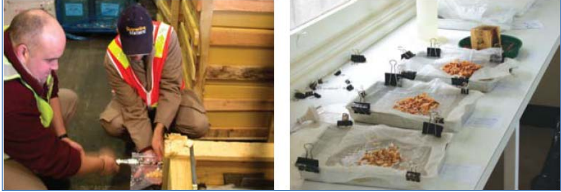
Şekil 6.11 Kasalardan alınan talaş örneklerinin laboratuvar ortamında incelenmesi (Quarantine risks associated with solid wood packaging materials receiving ISPM 15 treatments)
