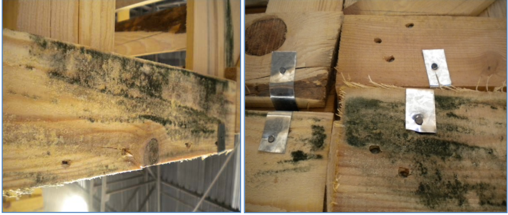
Şekil 6.9 İşlem sonrasında kasalarda mantar oluşumu
