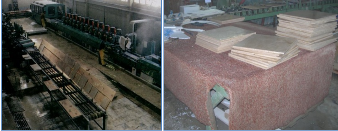
Şekil 3.14 Seleksiyon hattı, kalite kontrol ve seleksiyon masası
