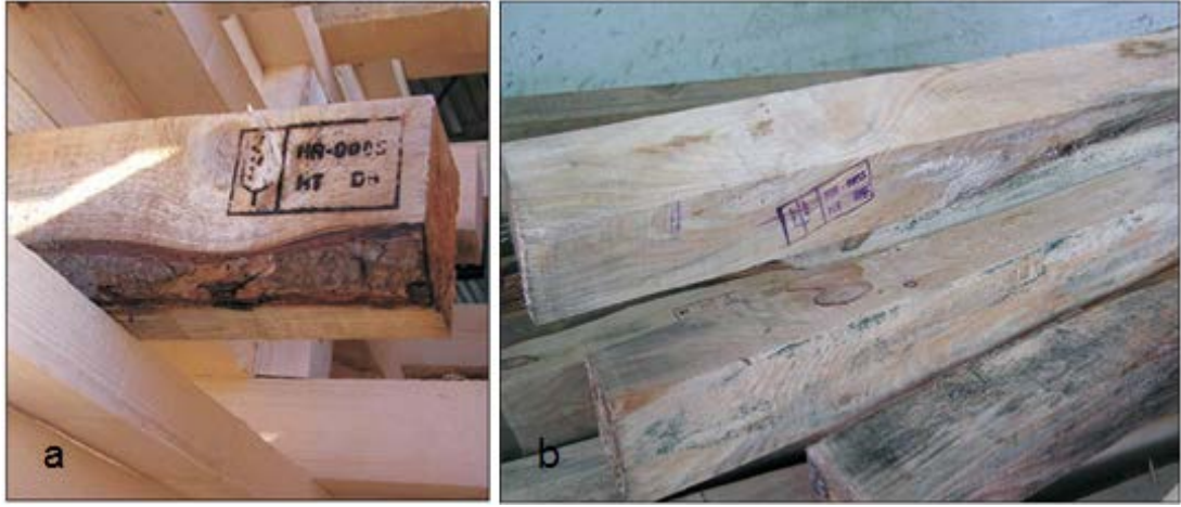
Şekil 6.13a. Paletler üzerinde fazla miktarda kabuk bulunması (Jambreovic, Despot, Hasan, 2010)
