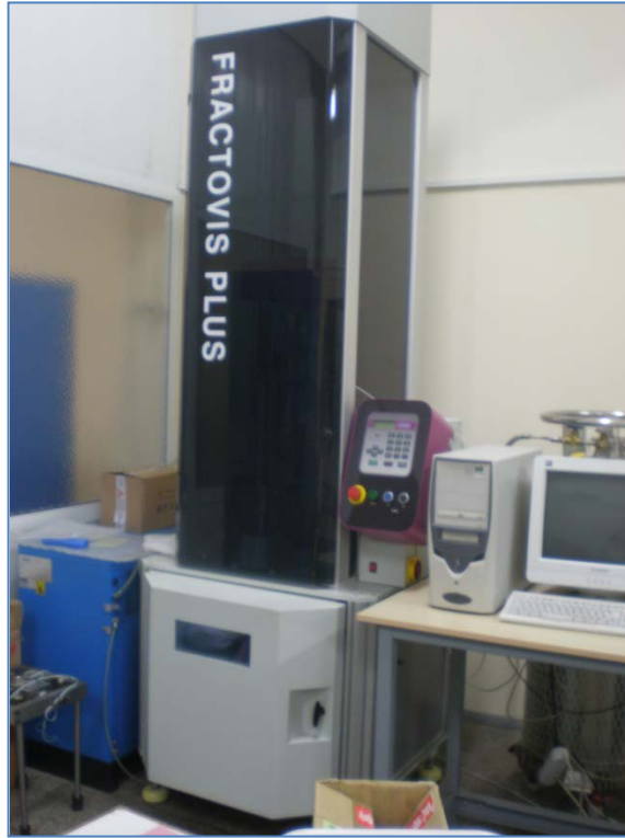
Şekil 6.26 Fractovis Plus darbe cihazı
