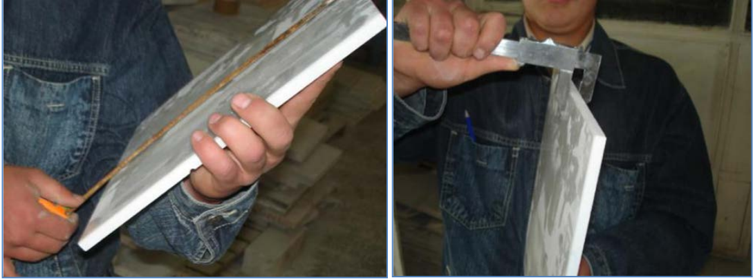
Şekil 3.16 Fayans boyut ve kalınlık kontrol
