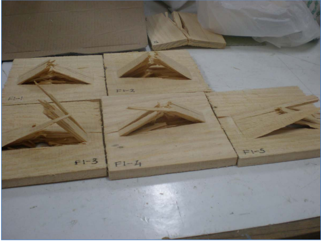
Şekil 6.27 Darbe deneyi sonrası ısı işlem görmüş çam örneklerinin durumu
