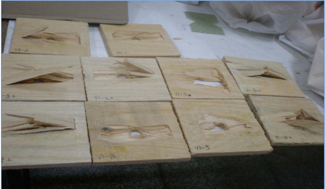
Şekil 6.28 Darbe deneyi sonrası ısı işlem görmemiş çam örneklerinin durumu
