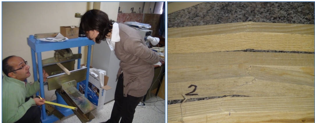
Şekil 6.22 Eğilme testi uygulaması ve sonucunda örneklerin durumu
