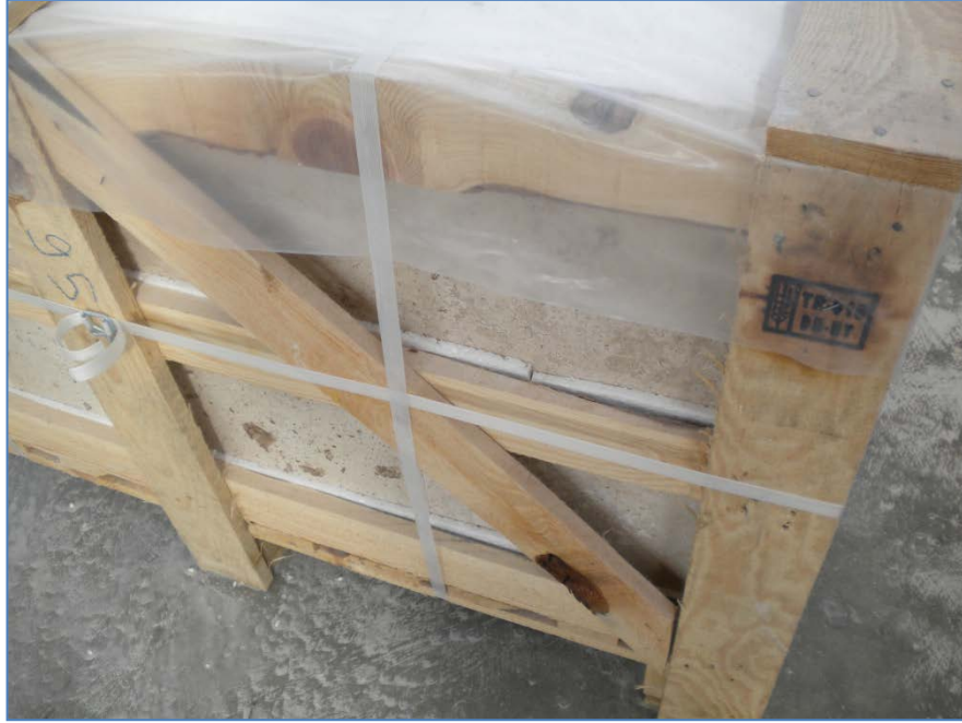
Şekil 5.2 Kasa üzerinde görülen ISPM 15 damgası
