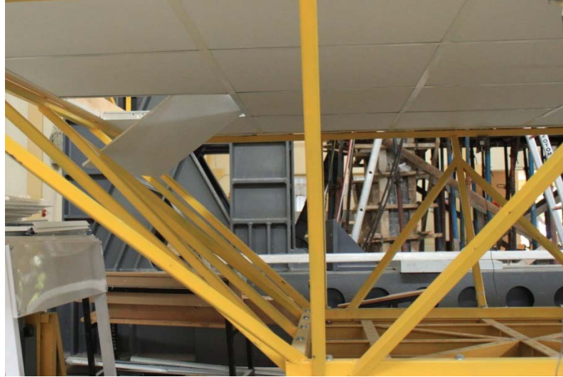
Şekil 6.12 Konfigürasyon 2-1 ATPYD D2-3 (1,44 g / 2,4 Hz) hasar görünümü
