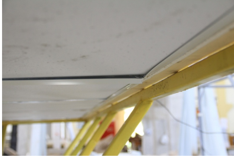
Şekil 6.20 Konfigürasyon 2-2 ATDYD D1-5 (0,96 g / 3,0 Hz) hasar görünümü
