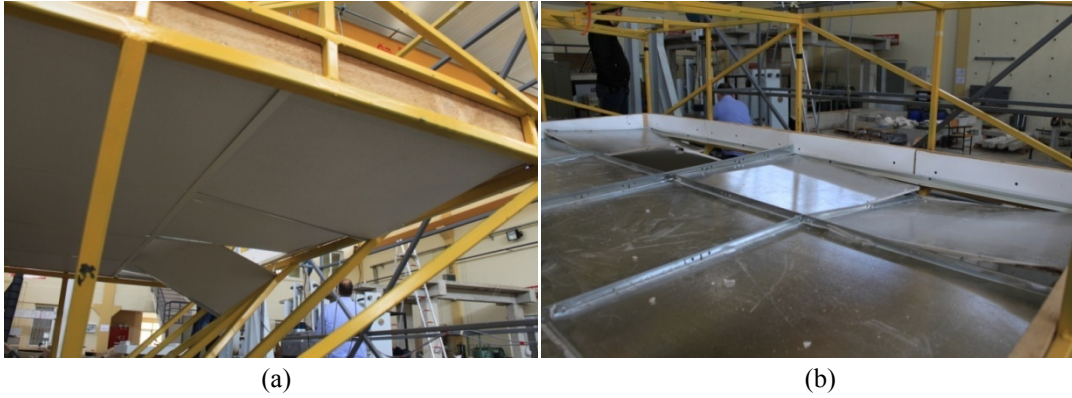
Şekil 6.18 Konfigürasyon 2-2 ATPYD (a) ve (b) D3-1 (1,92 g / 2,0 Hz) hasar görünümü
