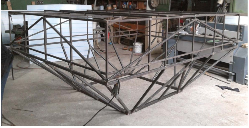
Şekil 3.10 Askı çerçevesi imalat sonrası görünümü
