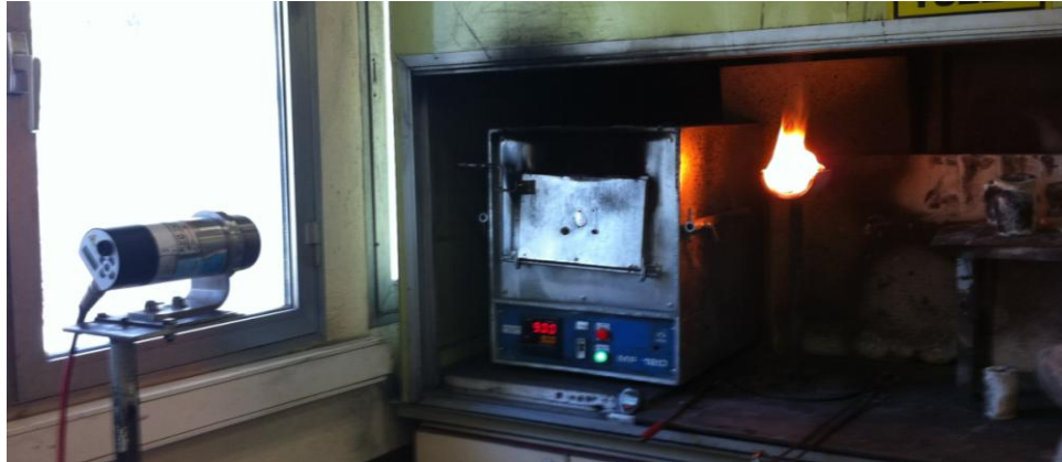
Şekil 4.7 Radyasyon pirometre ve termal çift ile alınan sıcaklık ölçümü düzeneği
