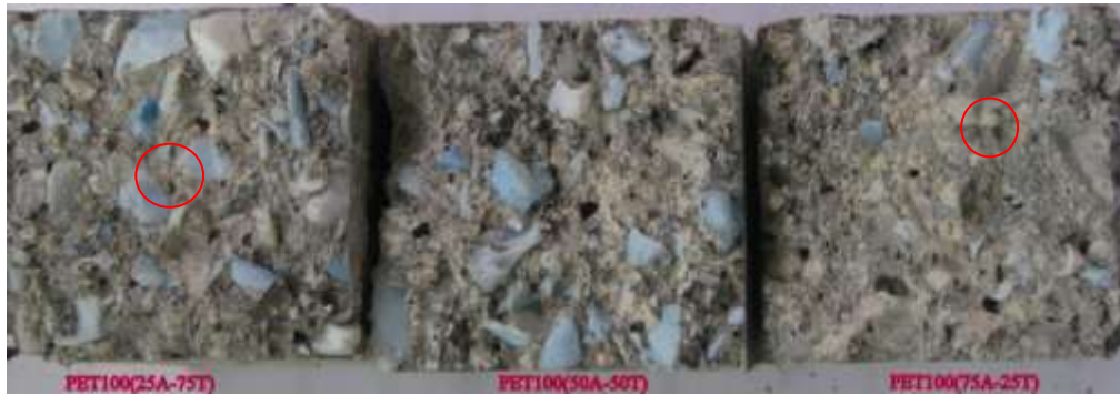
Şekil 7.14 Takoz ve agrom tipi pet agregaların karıştırılarak kırma kuma ikame edilmesi sonucu sertleşmiş harç örnek kesitleri.
