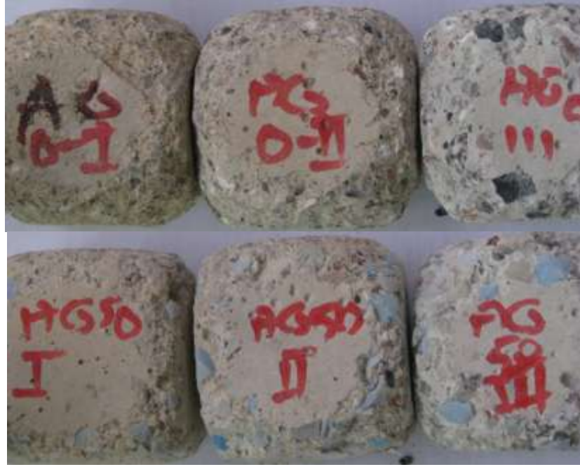
Şekil 7.53 Modifiye los angeles aşınma deneyi sonrası takoz ve agrom tipi pet agregası karışımının renkli agregaya ikame edildiği ve gri çimento yerine beyaz çimentonun kullanıldığı harçların görünümü.
