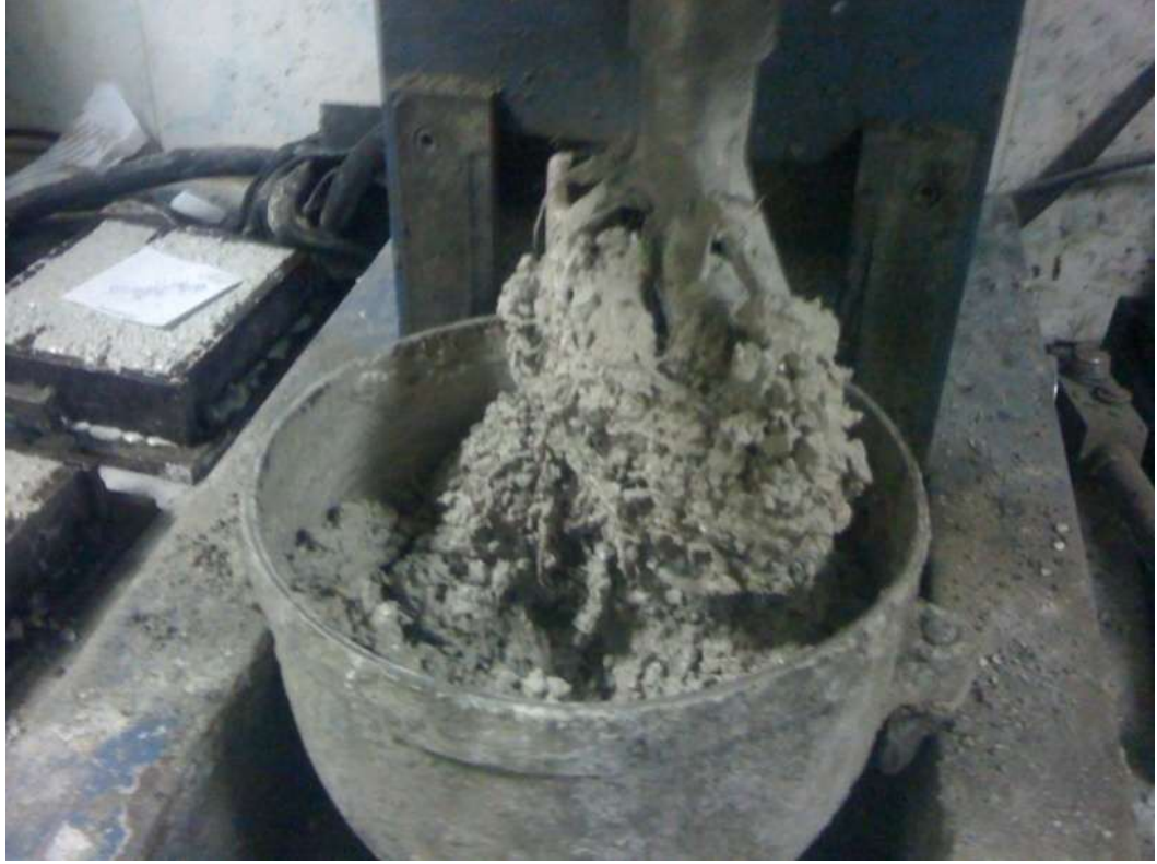
Şekil 6.9 Taze haldeki pet lifli harcın karıştırılması sırasında liflerin palet etrafında toplanması.
