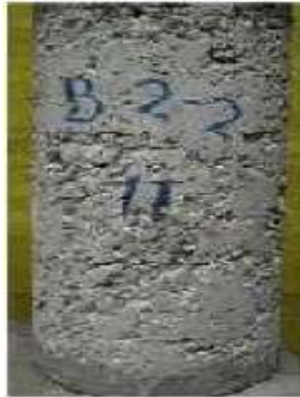
Şekil 3.10 Büyük boyutlarda kesilmiş pet şişe parçalarının betonda oluşturduğu boşluklu yapı (Akçaözoğlu ve Atiş, 2012).
