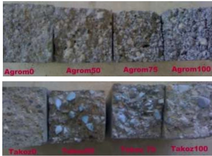
Şekil 7.5 Takoz ve agrom tipi pet agregaların ayrı ayrı kırma kuma ikame edilmesi sonucu sertleşmiş harç örnek kesitleri.
