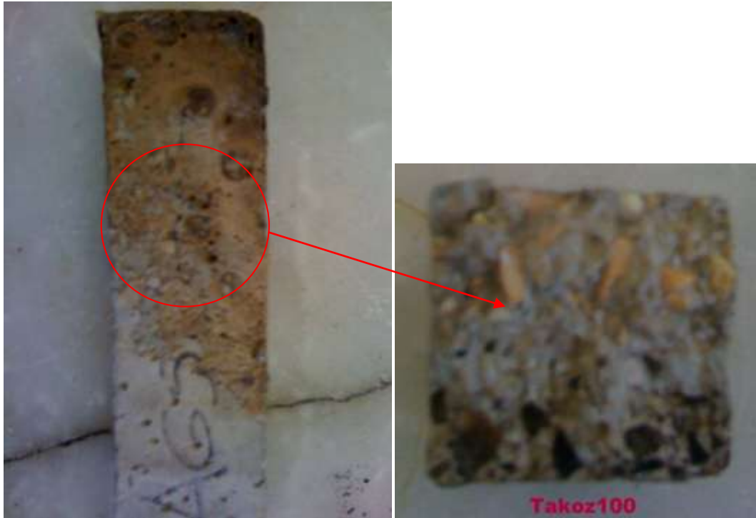
Şekil 7.7 Takoz tipi pet agreganın kırma kuma ikame edildiği sertleşmiş harcın 240 °C de 10 saat kaldıktan sonraki görüntüsü.
