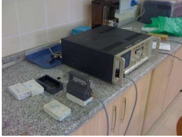
Şekil 6.23 Hot wire yönteminde örneklerin ısı iletkenlik değerlerinin ölçümü.
