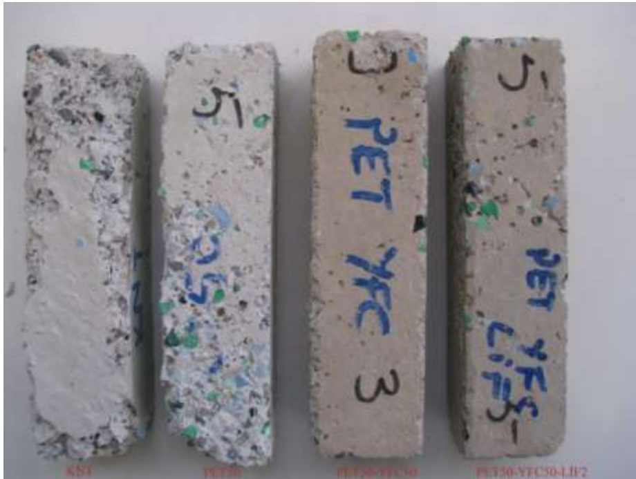
Şekil 8.16 Hazırlanan karışımların donma-çözülme etkisi sonrasında görünüşleri.
