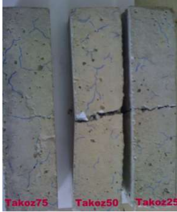
Şekil 7.10 Takoz tipi pet agreganın kırma kuma ikame edildiği sertleşmiş harcın 120 °C de 10 saat kaldıktan sonra harç örneklerinin yüzeyinde meydana gelen çatlaklar.
