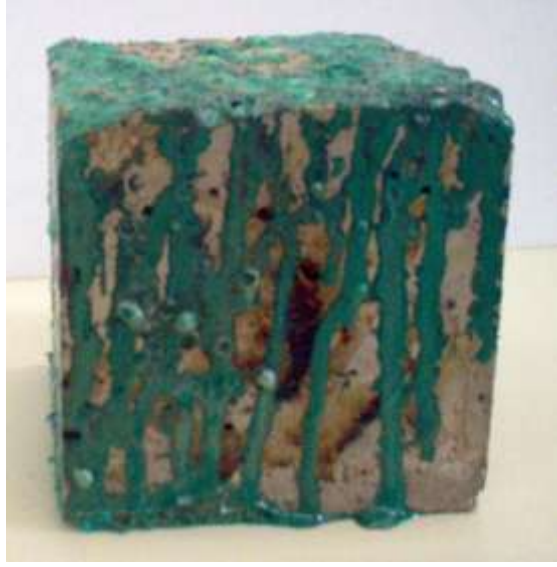
Şekil 3.8 250 °C'de 5 saat boyunca fırında kalan pet agregalı örneğin fırından çıktıktan sonraki görüntüsü (Kasselouri, 2009).
