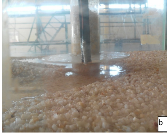
Şekil 3.7( b) Köprü kenarına yerleştirilen algılayıcı
