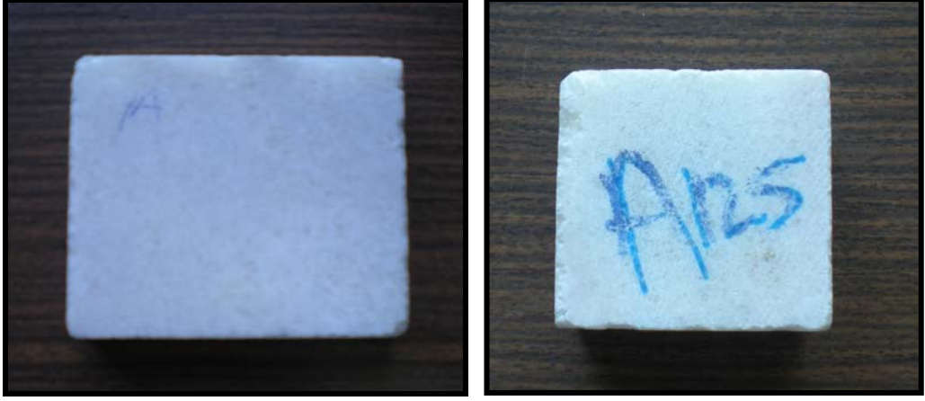
Şekil 7.13 İri kristalli mermerlerin donma-çözünme deneyi öncesi ve sonrası görünümü
