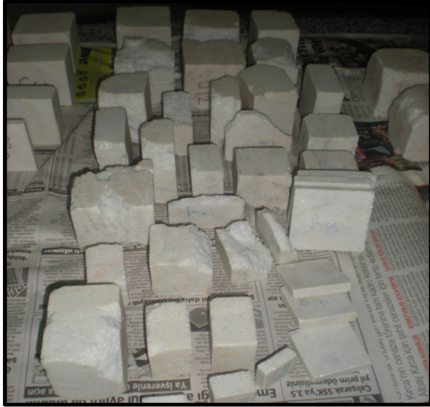
Şekil 7.29 Orta kristal boyutuna sahip mermer numunelerinin \text{Na}_2\text{SO}_4 tuz kristallenmesi deneyi öncesi ve sonrası görünümü
