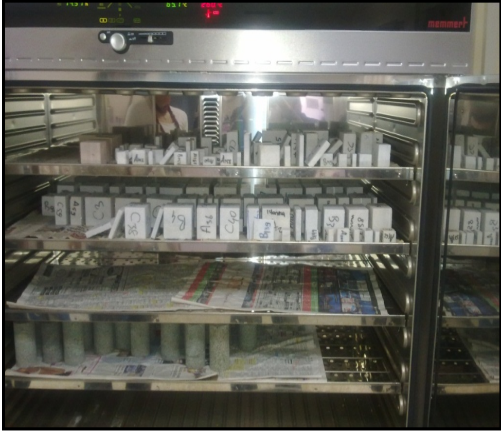
Şekil 7.10 İslanma kuruma deneyi sırasındaki Muğla mermerlerinin yüzey görüntüleri
