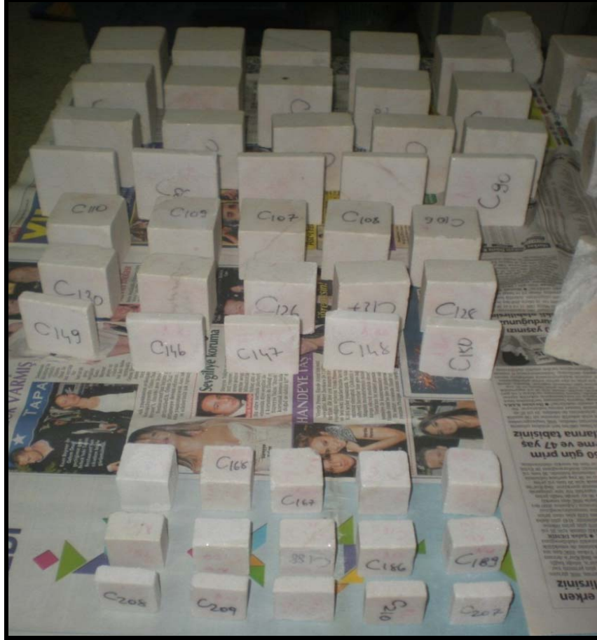
Şekil 7.30 .İnce kristalli mermerlerin tuz kristallenmesi deneyi öncesi ve sonrası görünümü
