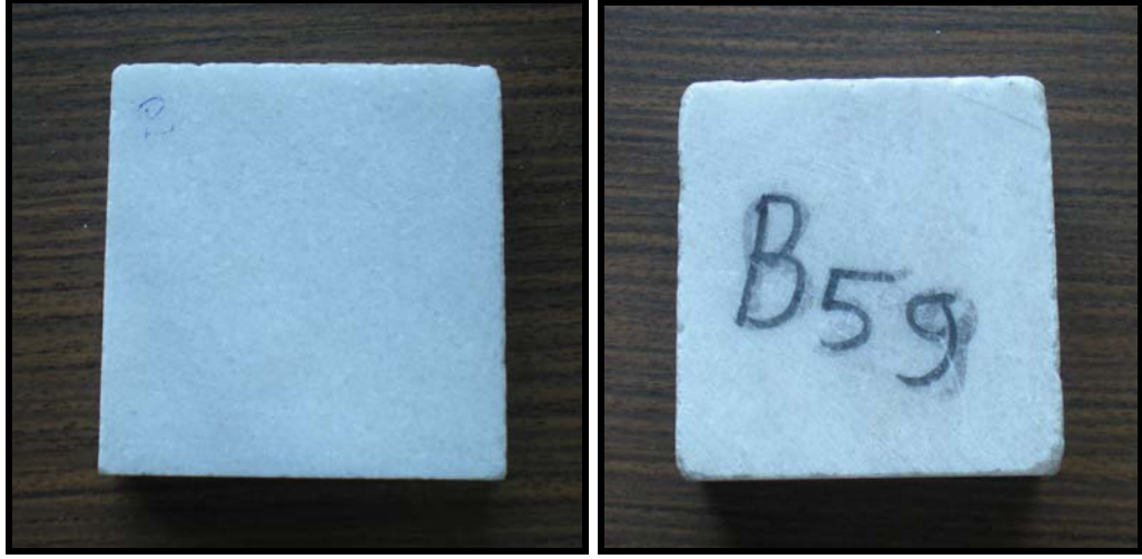
Şekil 7.2 Orta kristal boyutuna sahip mermerlerin ıslanma–kuruma deneyi öncesi ve sonrası görünümü
