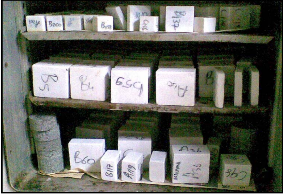
Şekil 7.11 İslanma kuruma deneyi sırasındaki Muğla mermerlerinin yüzey görüntüleri
