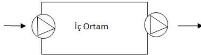
Şekil 2.6 Hava emişli ve basmalı havalandırma
