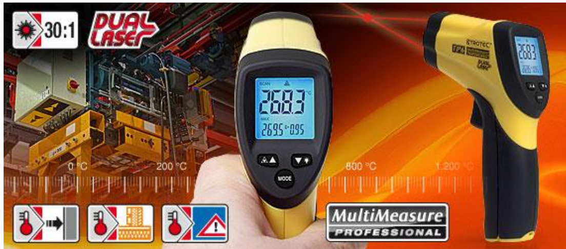
Şekil 6. 9 Yüzey sıcaklık ölçümlerinin alındığı lazer pirometre
