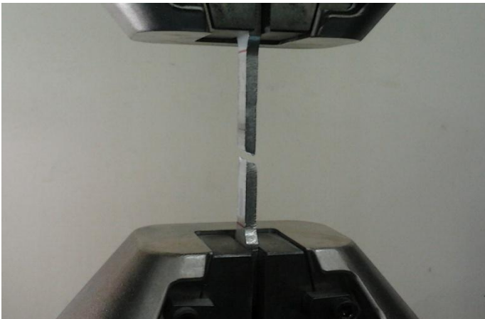
Şekil 7.18 Çekme testi sonucu kırılan numune
