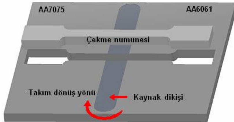
Şekil 6. 8 Numunenin plakadan çıkarılışı (SolidWorks Tasarımı)
