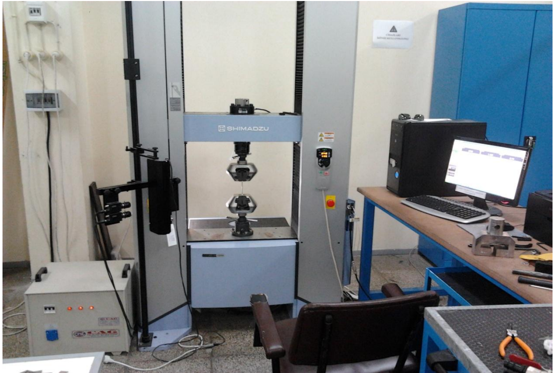
Şekil 6. 5 Çekme testlerinin yapıldığı çekme makinası
