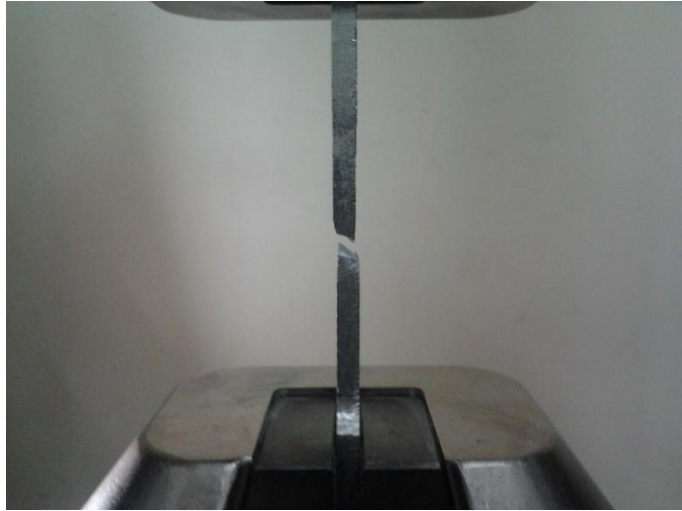
Şekil 7.17 Çekme testi sonucu kırılan numune
