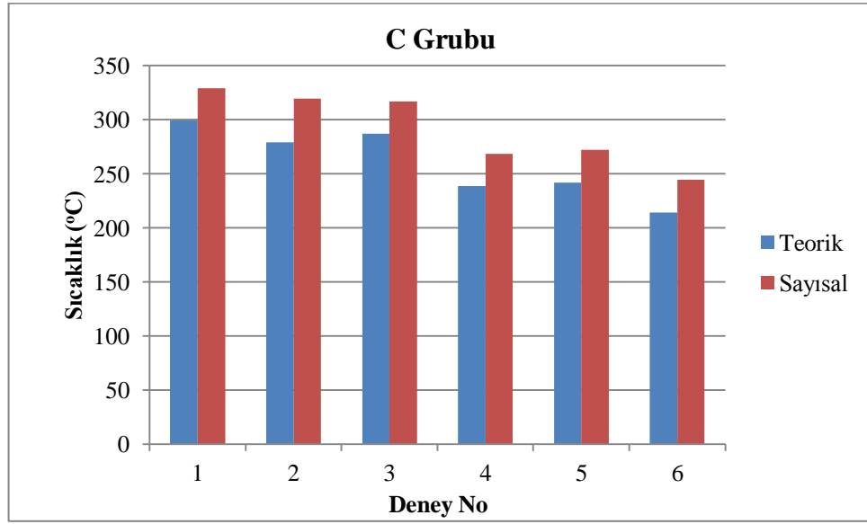
Şekil 7.20 C grubu deneylere ait deneysel ve sayısal sıcaklıklar
