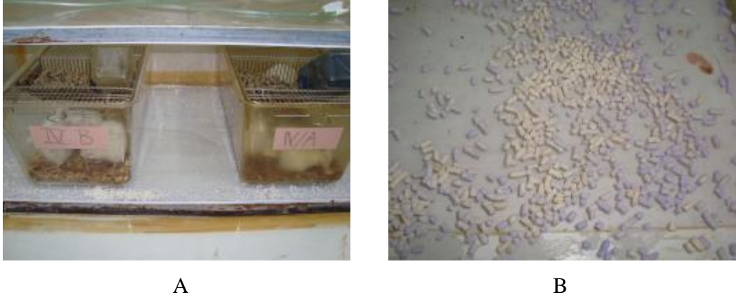
Şekil 3: Deney düzeneği (fanus) içinde soda lime granüllerinin kullanılması (A: Fanus tabanına serpilmiş olan soda lime granüllerinin görünümü; B: Soda lime granüllerinin iç ortam havasındaki karbondioksit moleküllerini bağladıktan sonra renginin beyazdan açık mora dönüşmesi)
