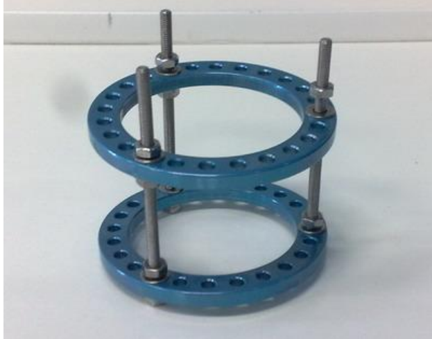
Resim 2: Deneylede kullanılan 24 delikli 2 halkalı 3 barlı distraktör
