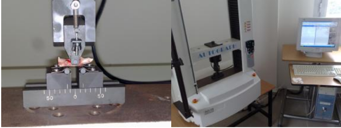
Resim 37: Üç nokta kırma (bending) testinin uygulanışı
