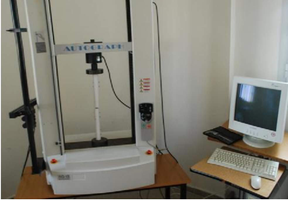
Resim 18. Biyomekanik testler Shimadzu 10kN Test Cihazında gerçekleştirildi.
