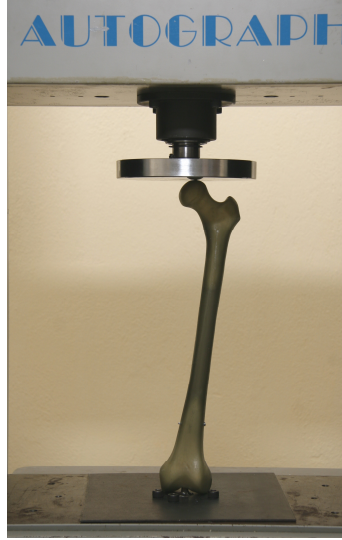
Şekil 13: 1. gruptan bir örneğin yüklenme testi
