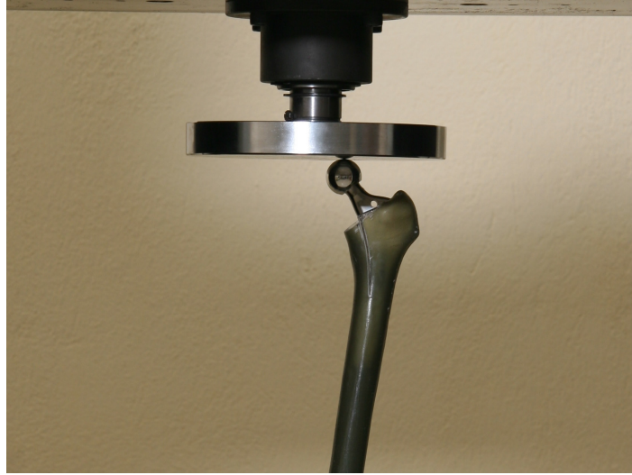
Şekil 18: 3. gruptan bir örneğin yüklenme testi
