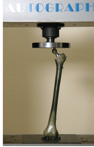
Şekil 20: 4. gruba ait bir örneğin yüklenme testi
