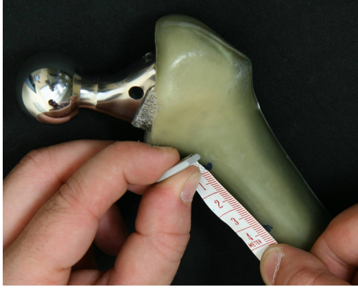
Şekil 16: Kırık modelinin oluşturulması
