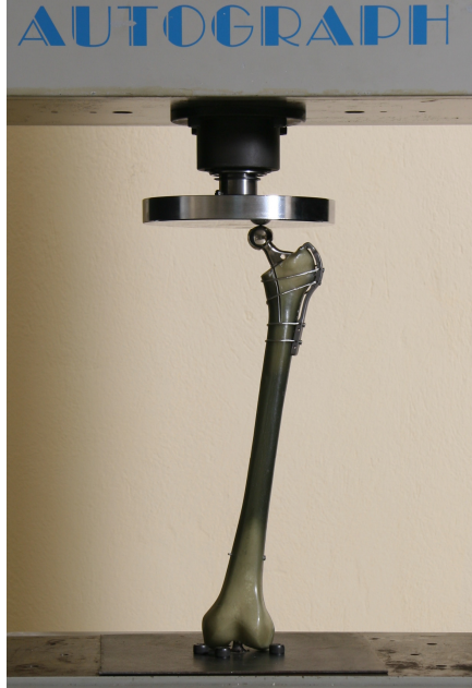
Şekil 26: 6. gruptan bir örneğin yüklenme testi
