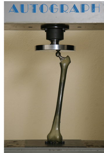
Şekil 15: 2. gruptan bir örneğin yüklenme testi
