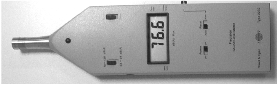
Şekil 17. Brüel&Kjær 2232 cihazı. Ekranda örnek bir ölçüm değeri (dB) görülmektedir.
