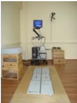
Şekil 1: Balans Master denge ve performans test cihazı
