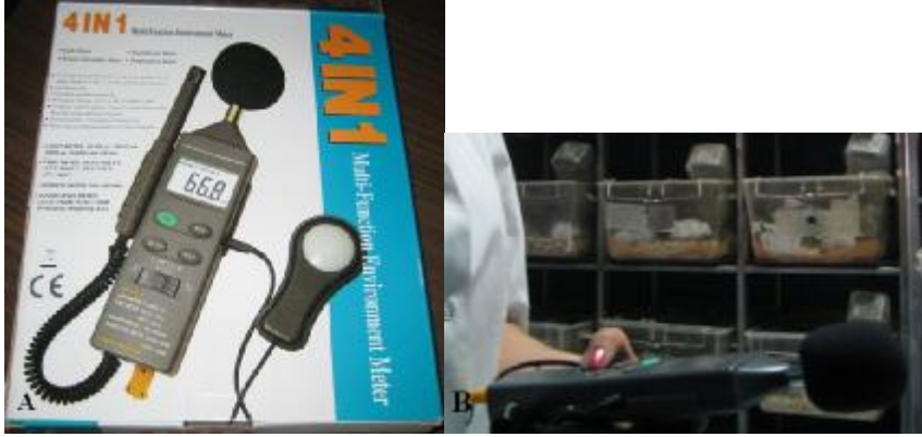
Şekil 2: DT-8820 çevresel ölçüm cihaz kutusu (A) ve cihazın kullanımı (B)
