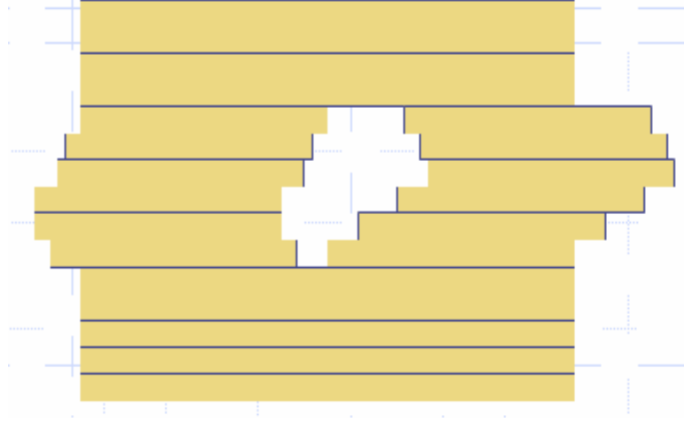
Şekil 12 : Çok yapraklı kolimatörlerin (ÇYK) şematik gösterimi
