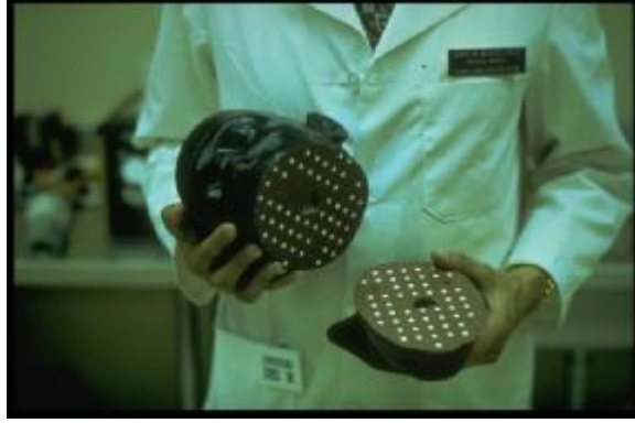
Resim 3: Baş-boyun bölgesi için Alderson Rando Fantomunun TLD yerleştirilen deliklerinin görünümü
