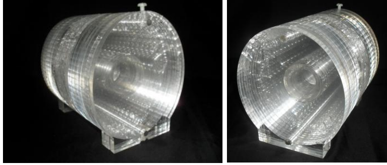
Şekil 20: Baş boyun fantom modelinde merkeze silindir kabın yerleştirilmesi.
