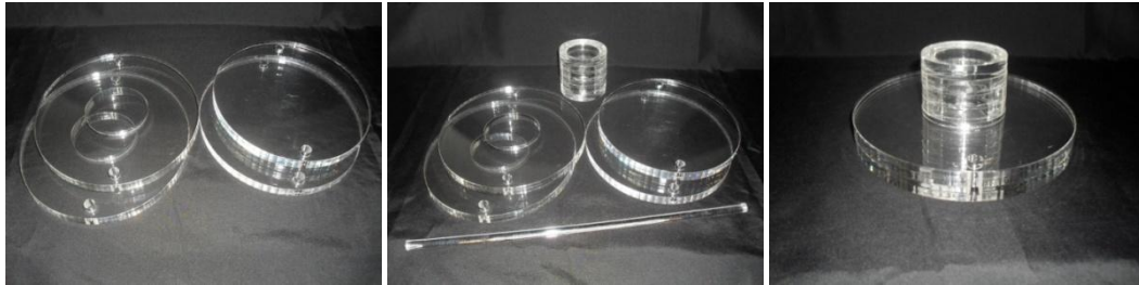
Şekil 18: Fantom modelinde kullanılan malzemeler ve silindir kap yerleşimi.
