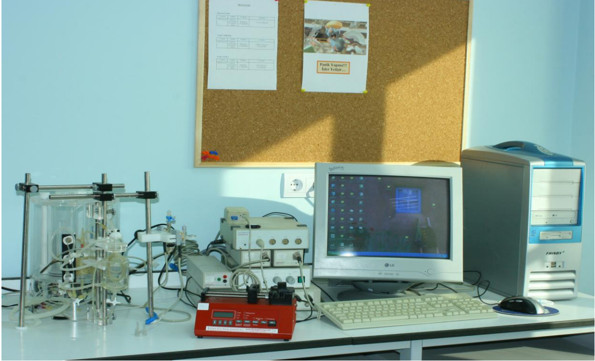
Resim 2. Kayıt işlemlerinin yapıldığı veri kayıt sistemi (Powerlab/8SP Data Acquisition System)
