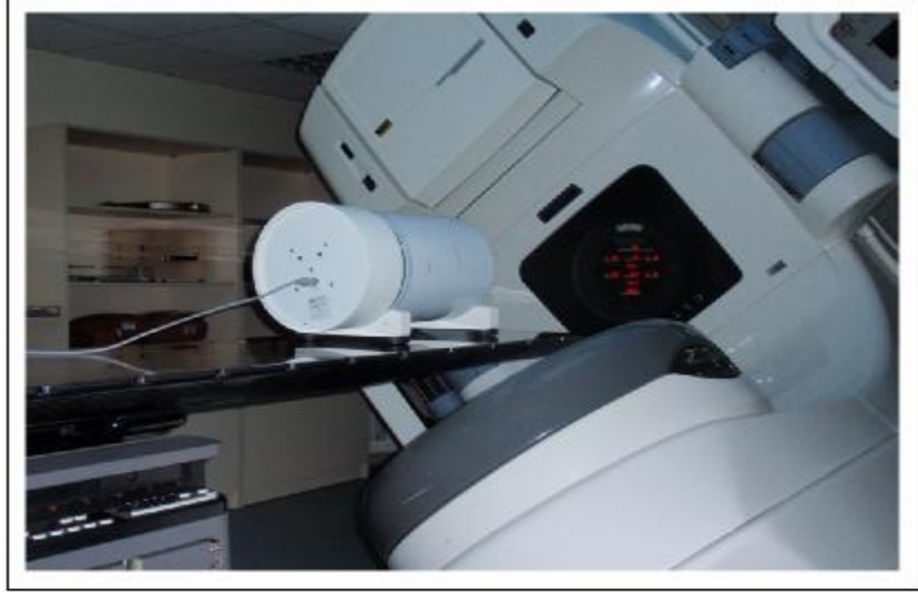
Şekil 25: ArcCheck ölçüm seti.
