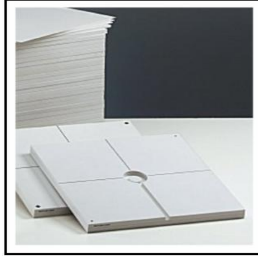
Şekil 17: Çalışmada kullanılan RW3 katı su fantomu.
