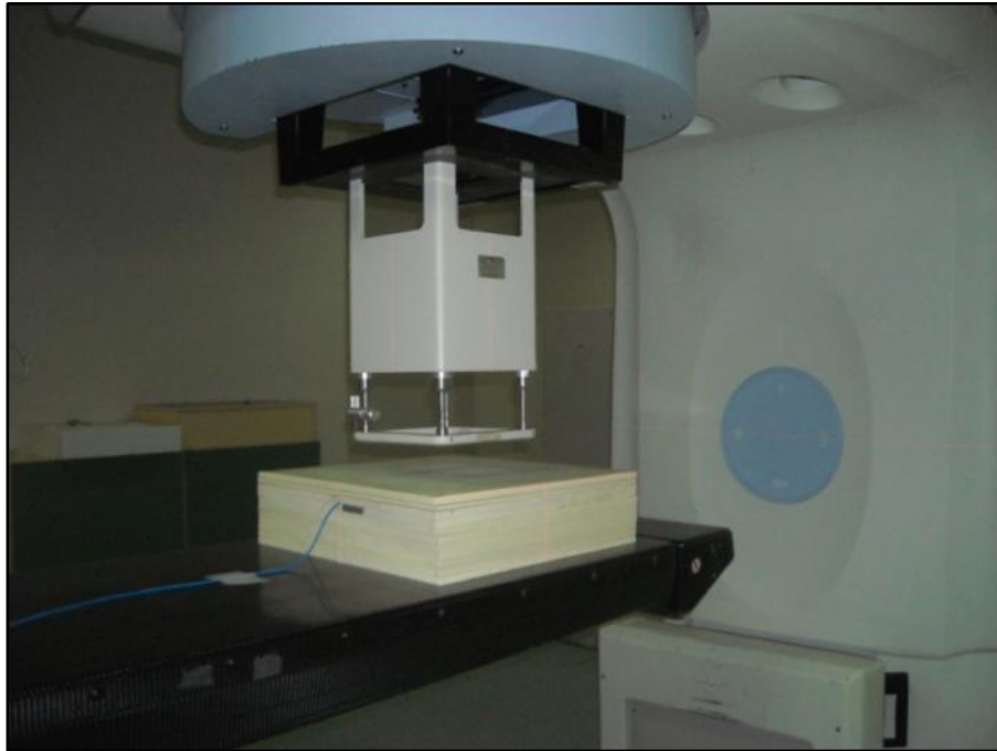
Şekil 14. Katı su fantomu ölçümleri için deney düzeneği.
