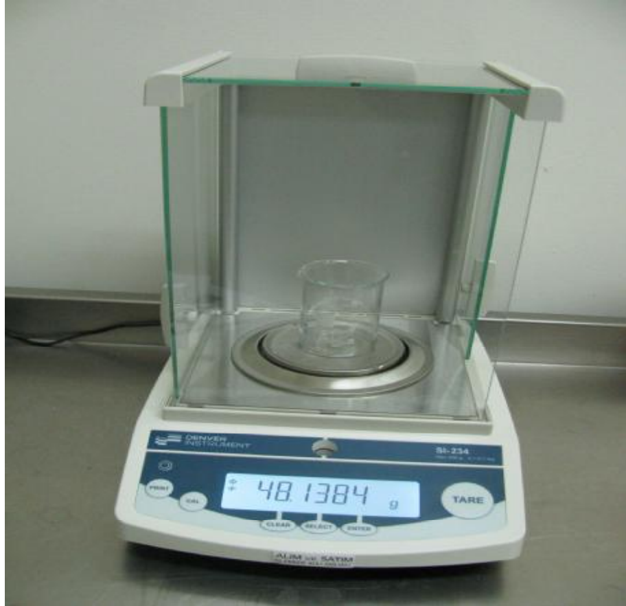
Şekil: 18 Hassas terazi (Denver Instrument Germany SI-234)
