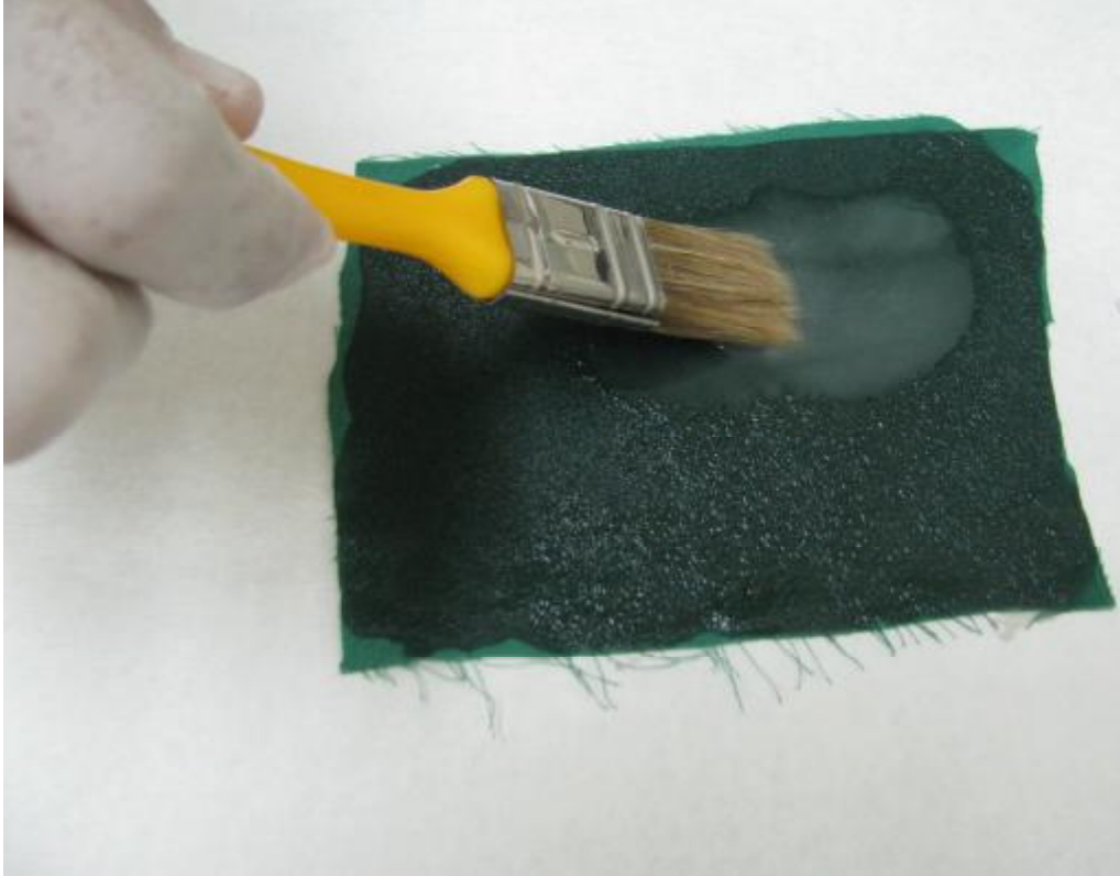
Şekil: 20 Sıvı haline getirilen elementlerin tekstil malzemesi üzerine sürülme işlemi
