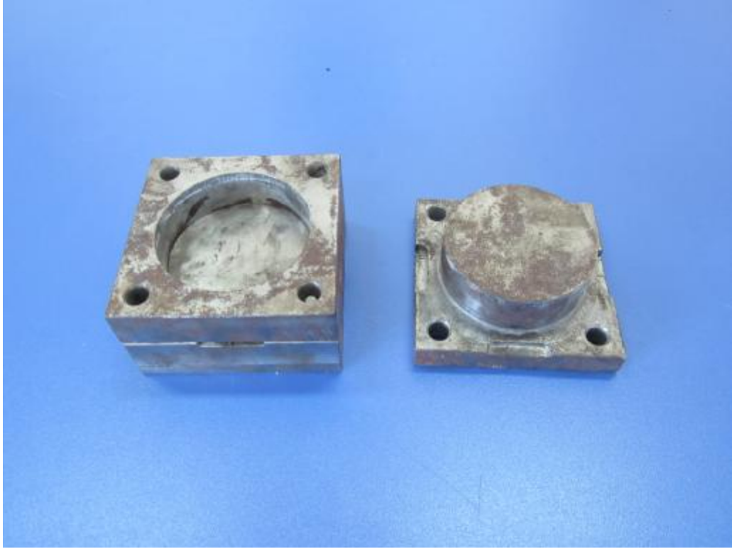
Şekil: 13 Toz malzemelerin preslenmesi sırasında kullanılan kalıp aparatı
