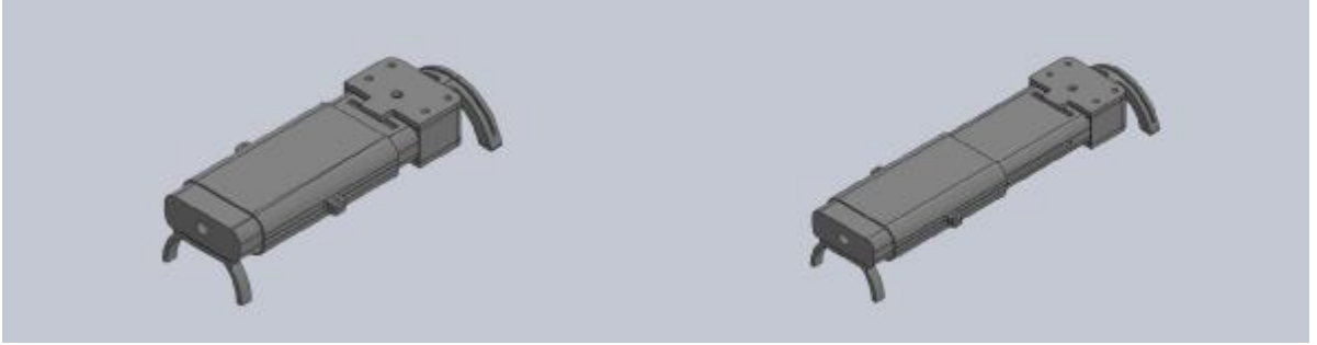
Şekil 7. Omurga navigasyon sisteminin Solidworks 2010 programında açık ve kapalı durumundaki tasarımı.
