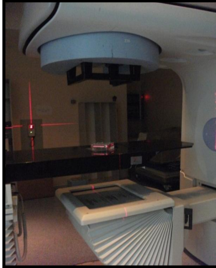
Şekil 16: Fantomun izosentra yerleştirildiği ikinci set-up .
