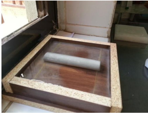
Şekil 10: Erimiş parafin ve merkezde Ti6Al4V protez örneği.
