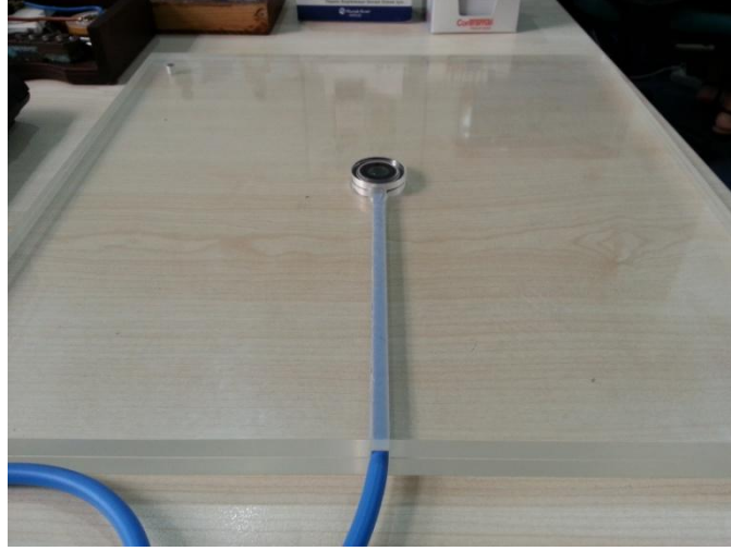
Şekil 15: Markus iyon odası plexiglass adaptör içinde.
