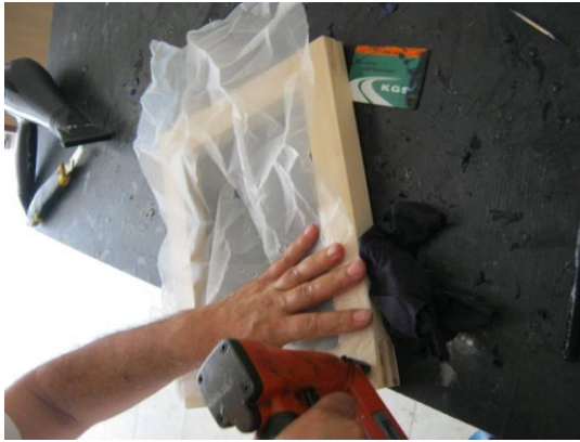
Resim80 : Elek bezinin ahşap çerçeveye gerilmesi
