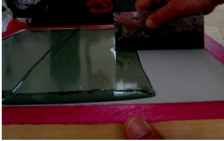
Resim 55 : Eleğe Emülsiyon çekilmesi
