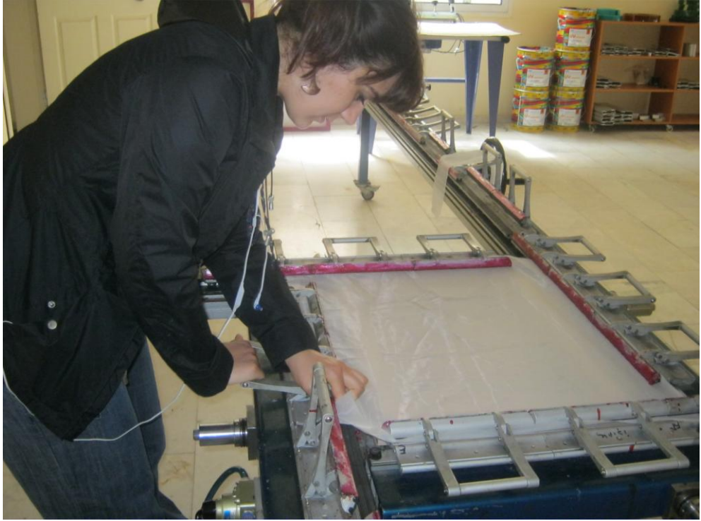
Resim43: Elek germe makinesinde elek germe işlemi
