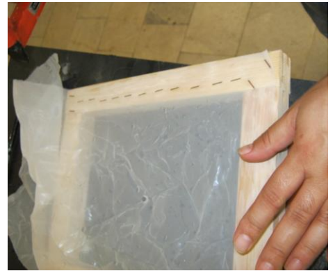
Resim80 : Elek bezinin ahşap çerçeveye gerilmesi
