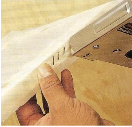
Resim 47: İpeğin zımba tabancası ile çerçeveye montajı
