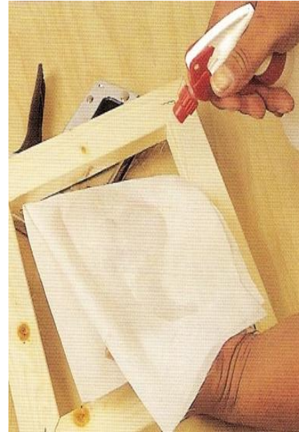
Resim 46: İpeğin gergin bir şekilde montajı için ıslatılması.
