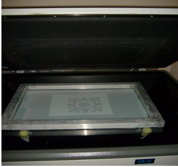
Resim 75 : Emülsiyonu çekilen eleğin pozlama aşaması
