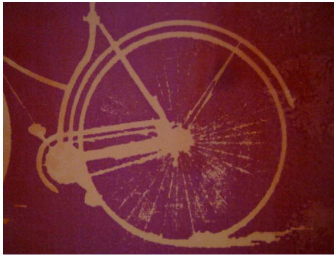
Resim81: Emülsiyonu kalın çekilen eleğin suyla yıkanmasından sonra
