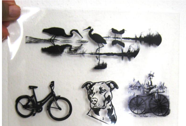
Resim53 : Serigraf baskı için asetata alınan film
