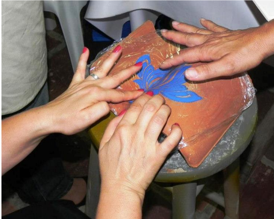
Resim 41: Pişmiş bünye üzerine dekal çıkartma tekniği
