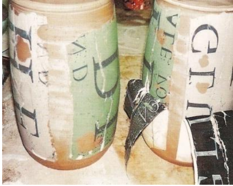
Resim 32: Kâğıdın kaldırılarak transferin ortaya çıkartılması.
