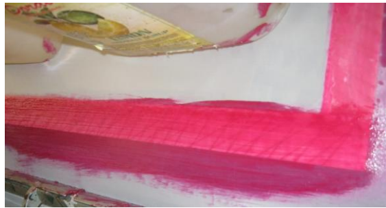
Resim 72: Yapışkanın eleğe sürülmesi
