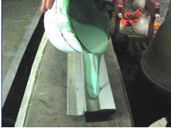
Resim 74: Emülsiyon un ragleye dökülmesi
