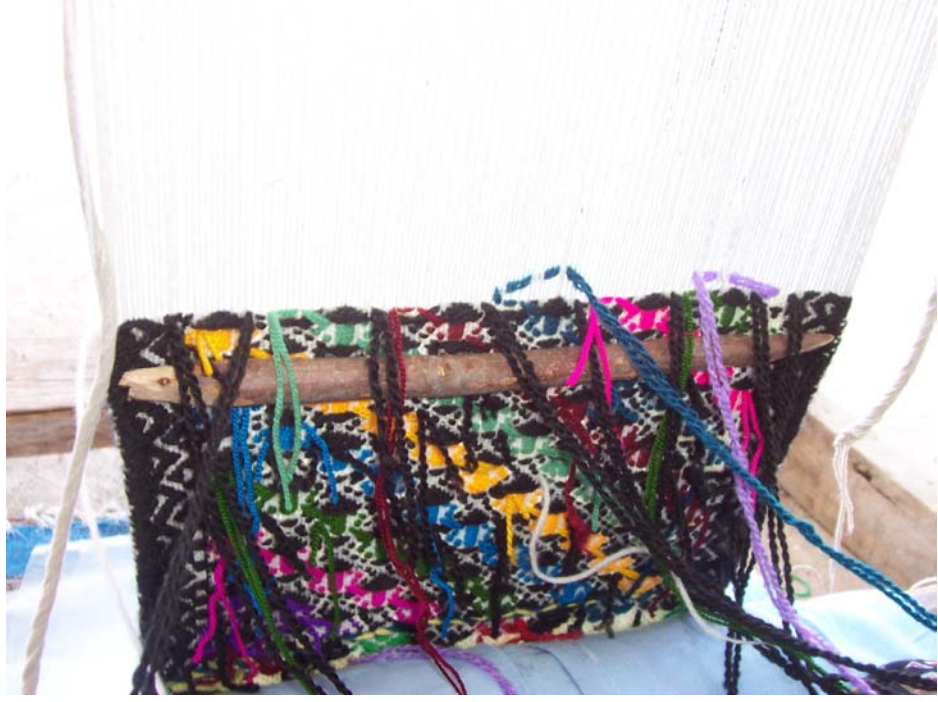
Fotoğraf 77: Kenarların Düzgün Olması İçin Takılan Çımbar, 22.03.2008
