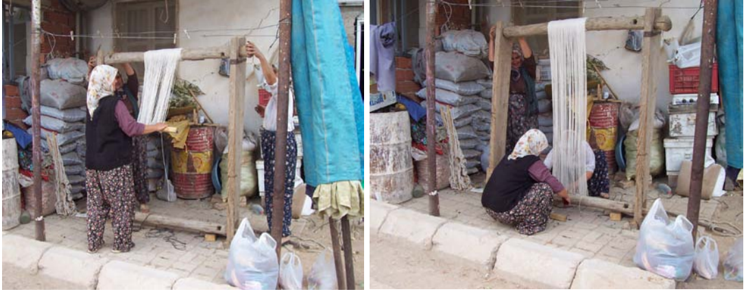
Fotoğraf 55-56: Çözü İpliklerinin Tezgâha Yerleştirilmesi, 08.11.2008
