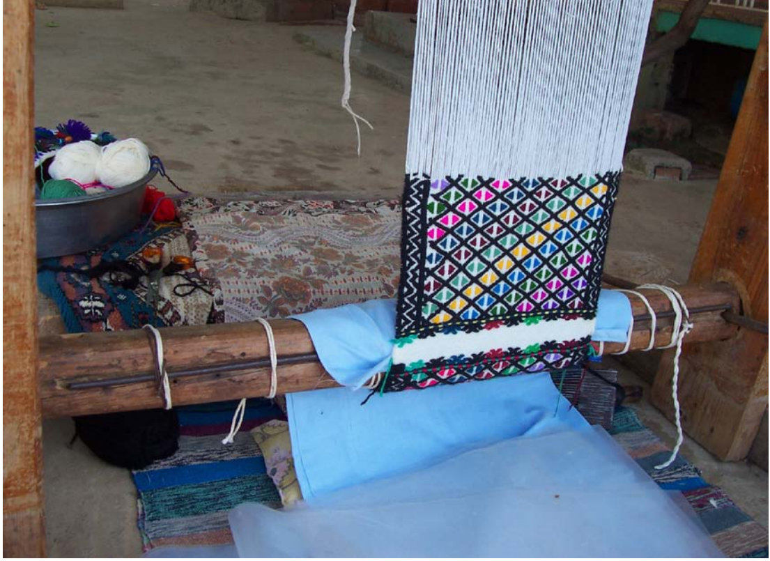
Fotoğraf 78: Dokumanın Zarar Görmemesi İçin Kumaş Parçası İle Örtülmesi, 22.03.2008
