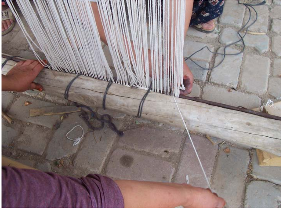
Fotoğraf 57: Çözü İpliklerinin Mezar Oyuğu İçerisinden Çıkmaması İçin Bağlanması, 08.11.2008
