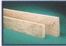
Şekil 2.2 Tabakalı yonga ahşap (WEB_1, 2003)
