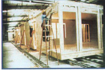
Şekil 3.21 Yapı bileşenlerinin fabrika ortamında bir araya getirilerek binanın hazırlanması (WEB_11).
