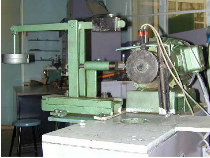
Şekil 4.9 Aşınma deneyinde kullanılan test cihazı
