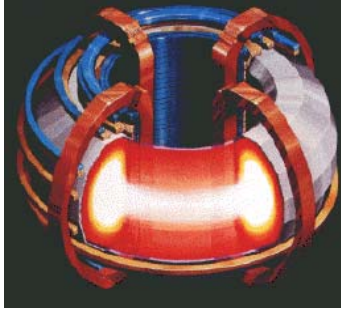
Şekil 2.6 Bir füzyon reaktöründeki sıcak plazma ve enerji yoğunluğunun magnetik sıkıştırma ile artırılması
