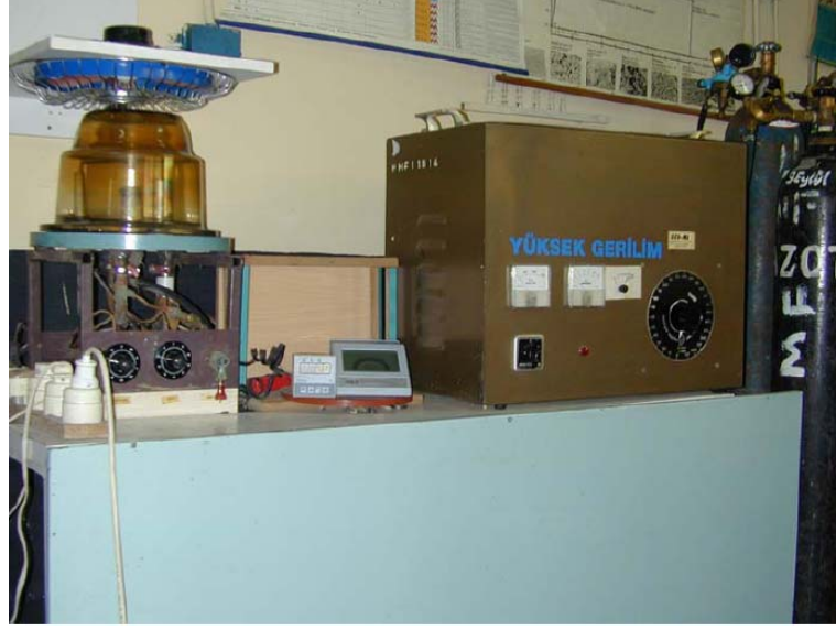
Şekil 4.6 Plazma nitrüleme sistemi
