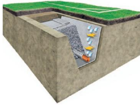
Şekil 1.21 Jeotekstillerin filtrasyon fonksiyonu (www.fibertex.com, 2008)
