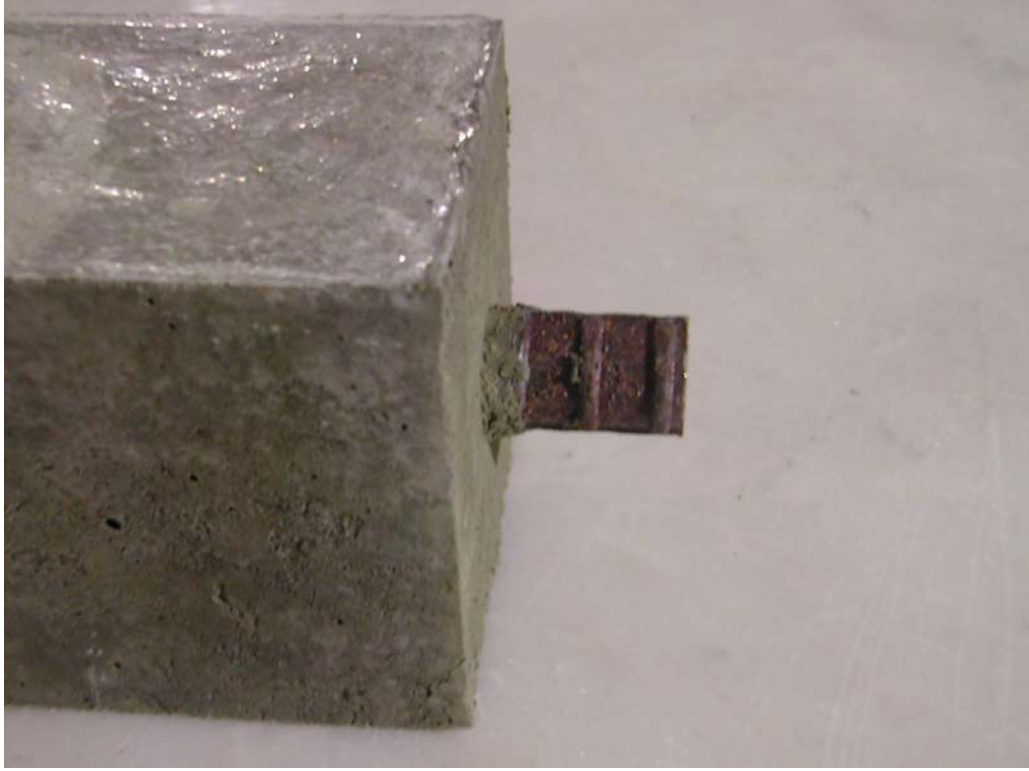
Şekil 6.13 İlk kür periyodunda donatıda gelişen paslanma.
