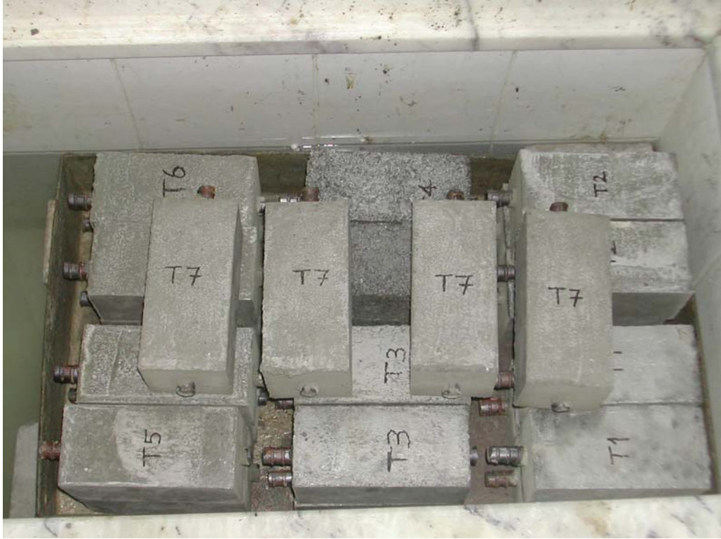
Şekil 6.12 Kür ortamındaki numuneler (t: 15–20 °C, BN: >%90).
