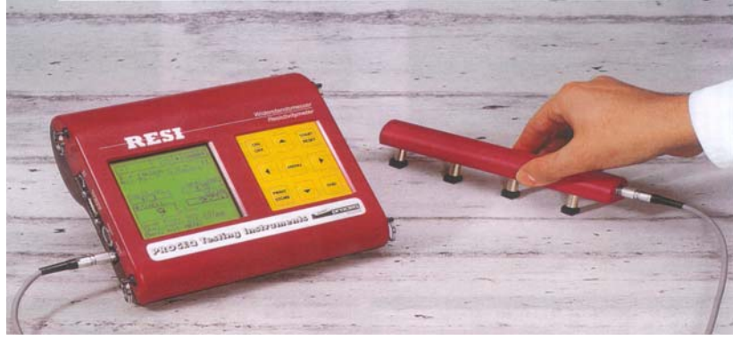
Şekil 4.12 Betonda direnç ölçümü.
