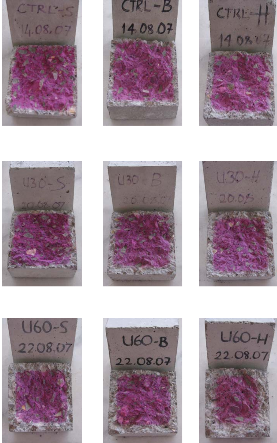
Şekil 9.8 Kontrol betonu ve uçucu küllü betonlarda 1 yıl sonunda karbonatlaşma görünümleri.
