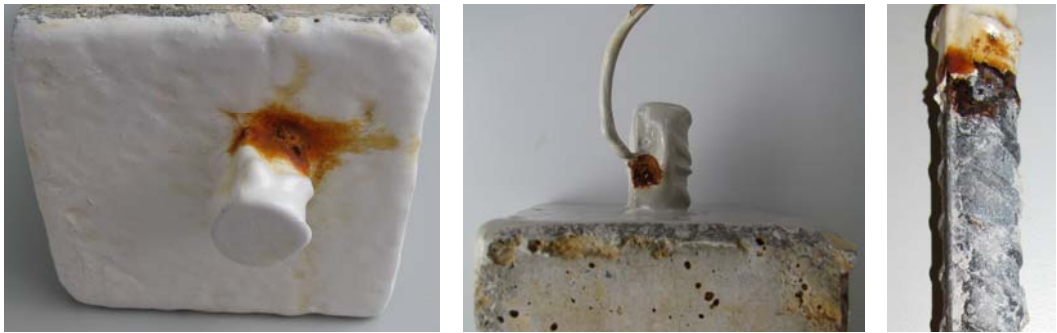
Şekil 10.14 Epoksi kaplamanın sağlıklı yapılamadığı örneklerde istenmeyen korozyon gelişimi.
