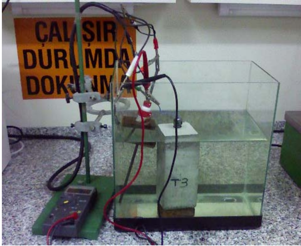
Şekil 6.19 Ölçümlerde kullanılan elektrokimyasal hücre.
