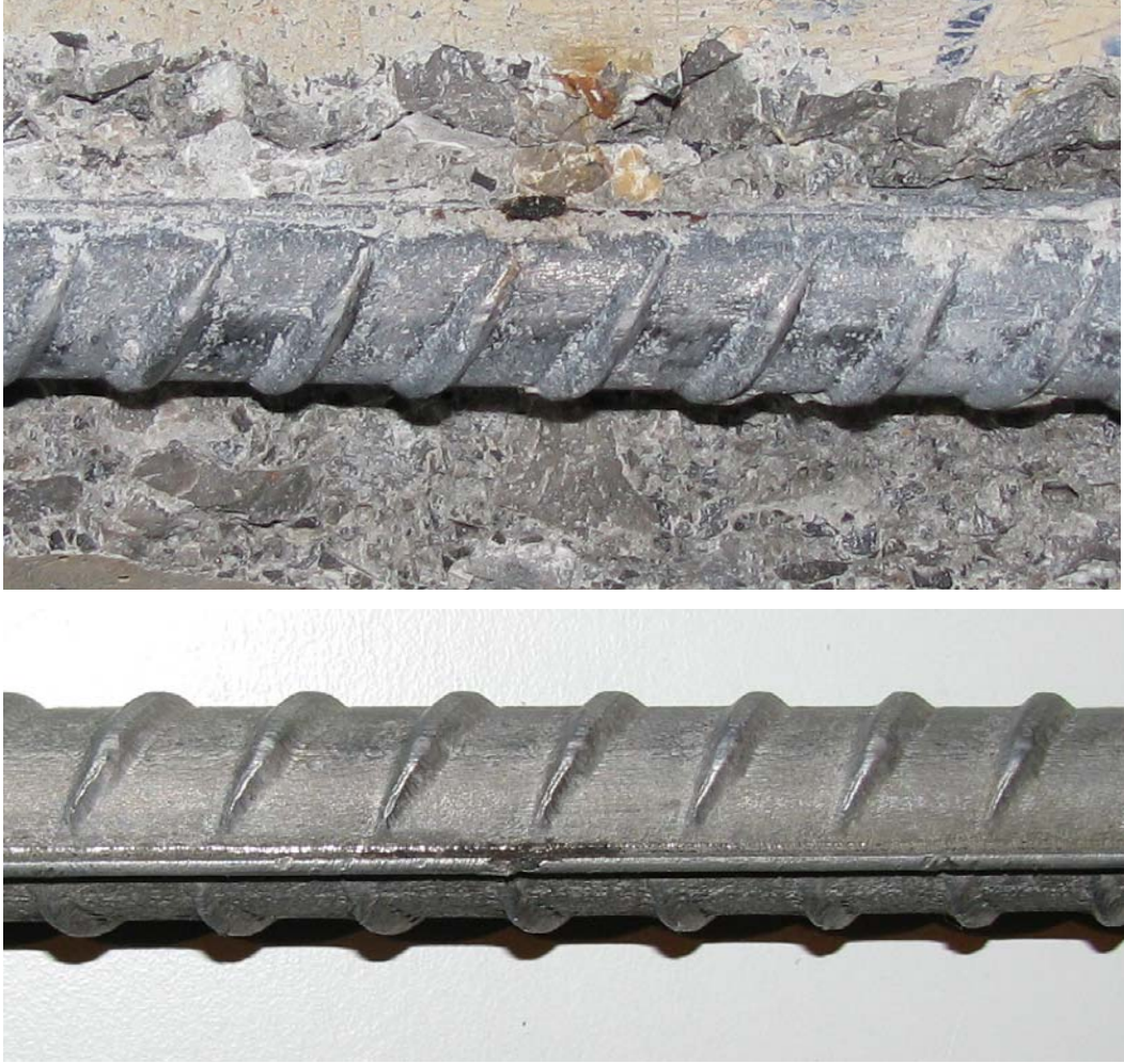
Şekil 10.12 Lokal korozyon gelişimi ve çelik donatıda malzeme kaybı.
