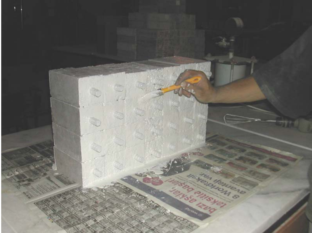
Şekil 6.17 Açıkta kalan donatıların ve prizma tabanlarının epoksi ile kaplanması.
