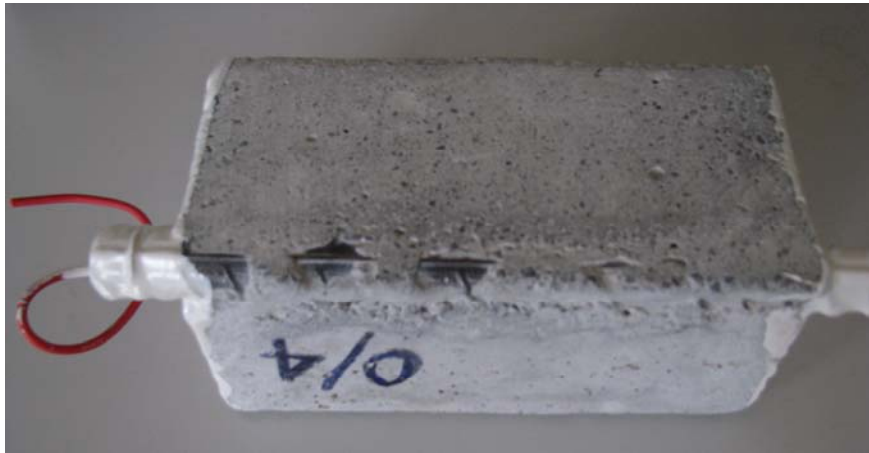
Şekil 10.2 Donatı yüzeyinde kısmen çimento şerbeti olan örnekler.
