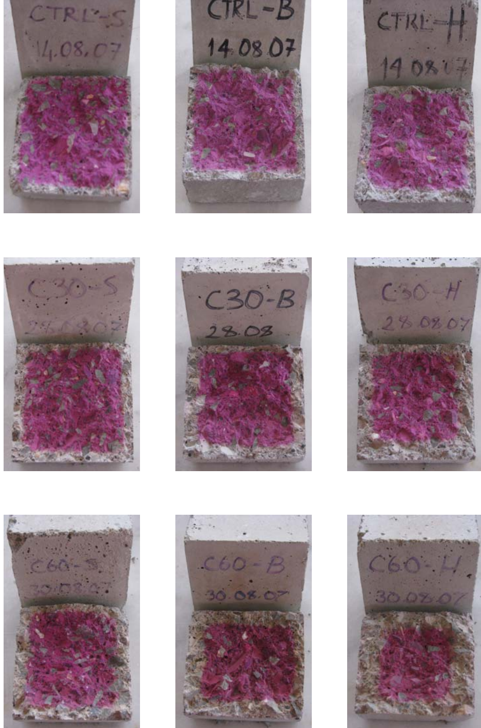
Şekil 9.9 Kontrol betonu ve cüruflu betonlarda 1 yıl sonunda karbonatlaşma görünümleri.
