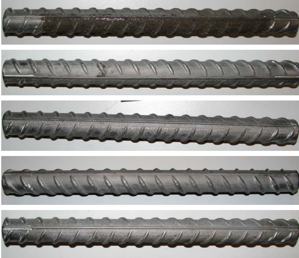
Şekil 10.17 Pas ürünleri ve beton kalıntılarından temizlenmiş donatıların görünümü (yukarıdan aşağıya sırası ile paspayı tabakası kalınlığı 0, 5, 10, 20 ve 30 mm).
