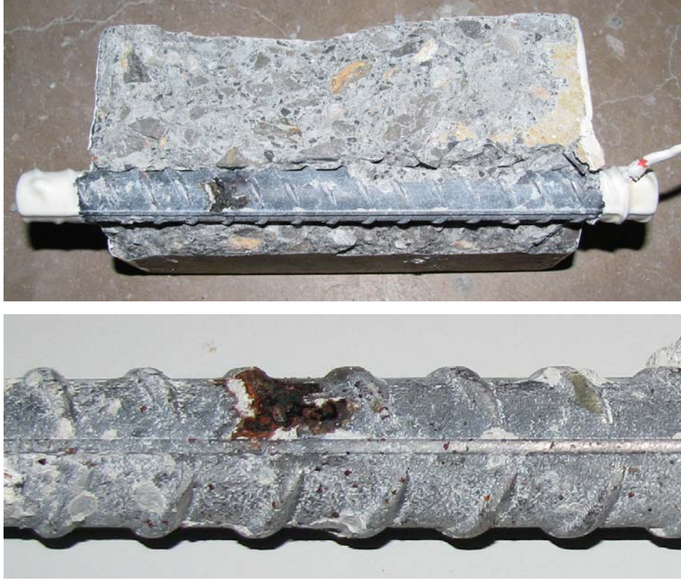
Şekil 10.9 Betonarme örneklerde klorür etkisi sebebiyle lokal korozyon gelişimi.
