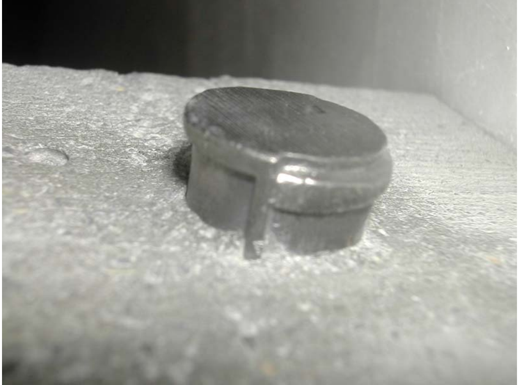
Şekil 6.16 Açıkta kalan çelik donatı (7. günde, temizleme işleminden sonra).
