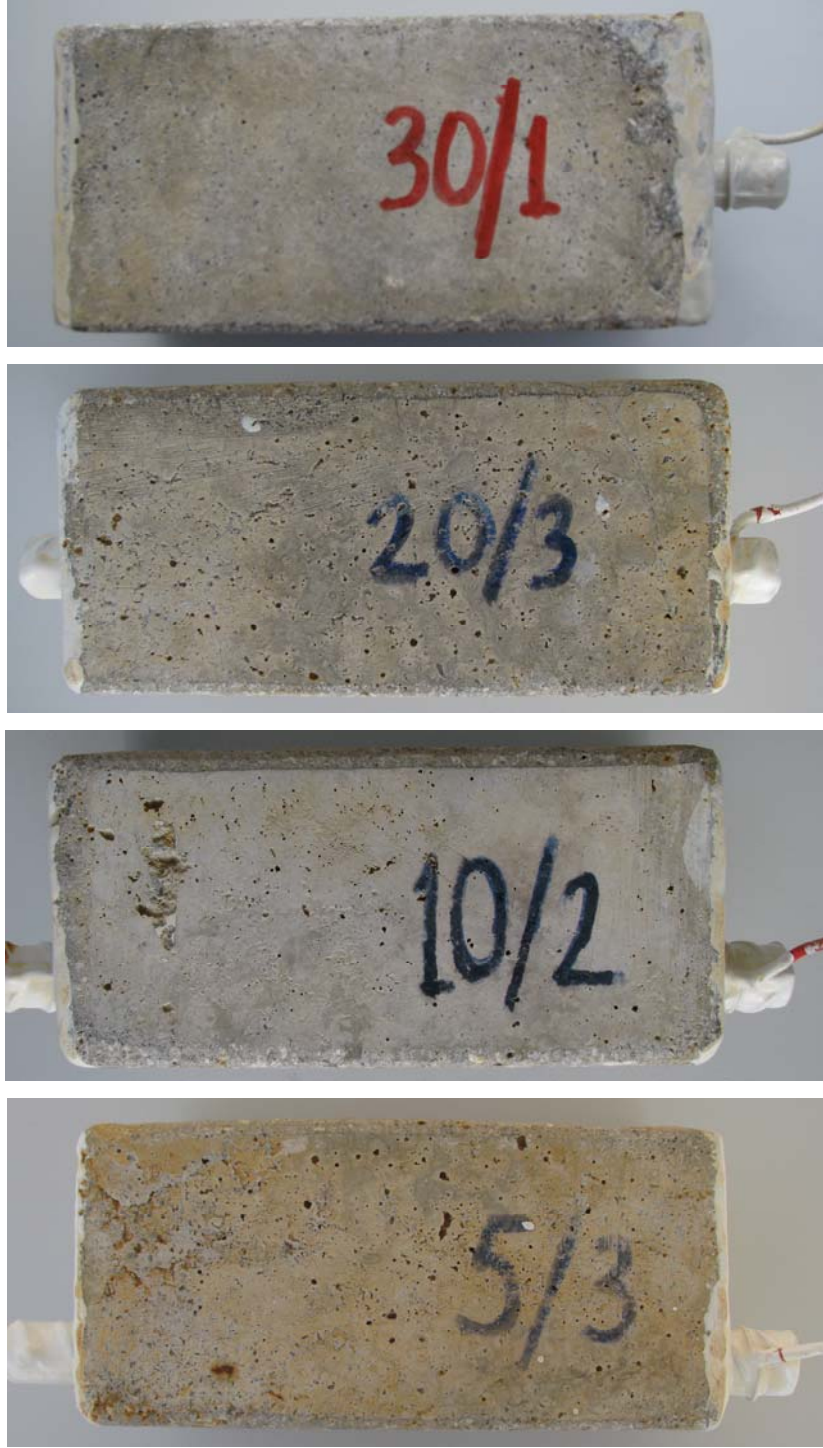
Şekil 10.7 Değişik paspayı tabakası kalınlığına (sıra ile 30, 20, 10 ve 5 mm) sahip örneklerin görünümü.
