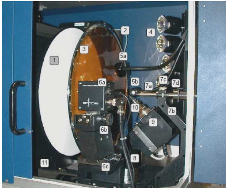
Şekil 2.3 IPDS II cihazının iç kısmının ayrıntıları: (1) Görüntüleme plakası (GP), (2) Okuyucu kafa, (3) Ana ışın tutucusu, (4) Silici ışıklar, (5a) ve (5b) Örnek aydınlatma lambaları, (6) Video kamera, (6a) Kameraları hareket ettiren tutucu, (6b) Optik kısım, (7a) Eksenleştirici, (7b) Eksenleştirici tutucusu, (7c) Ek sabitleme vidası, (7d) Güvenlik düğmesi, (8) Omega dönü eksen, (9) Phi eksen-örneği döndüren eğik eksen, (10) Gonyometre başlığı, (11) Görüntüleme plakası taşıyıcısı.
