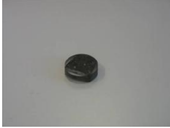
Şekil 5.2 Çimento harcı için hazırlanmış parlak kesit
