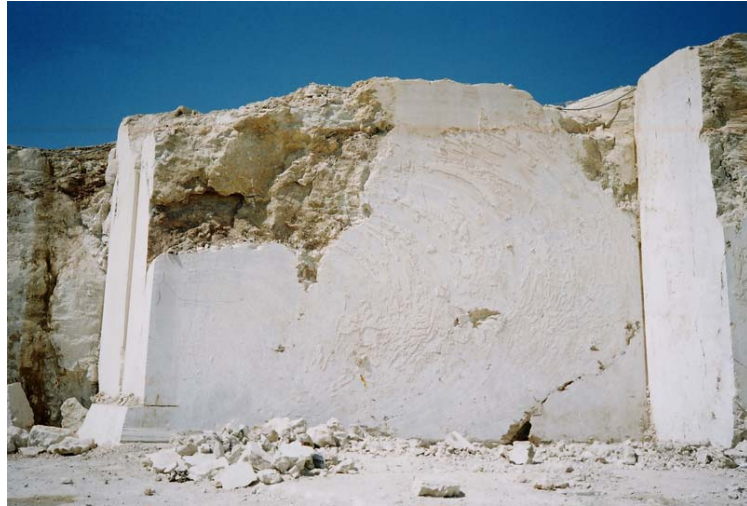
Şekil 6.87 3.kademe 2. aynada görülen süreksizlikler ve ölçüm hattı
