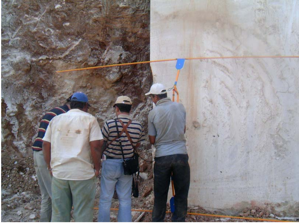
Şekil 6.64 GPR cihazı ile basamak aynasında yapılan ölçüm çalışması
