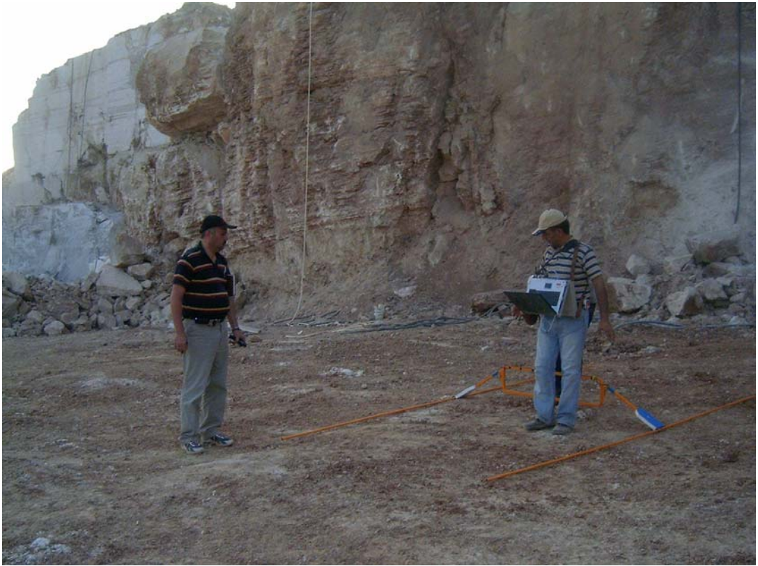
Şekil 6.63 Yer radarı ile basamak zemininde yapılan ölçüm çalışması
