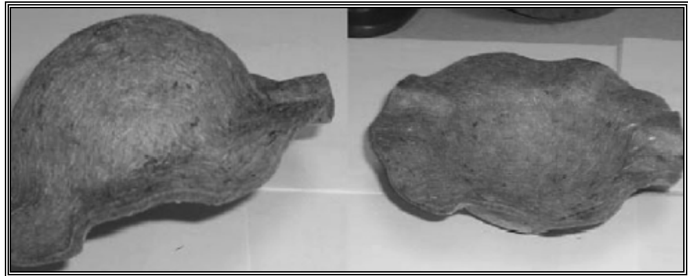
Şekil 2.2 Isıyla şekillendirilmiş Kenaf/PP kompozit
