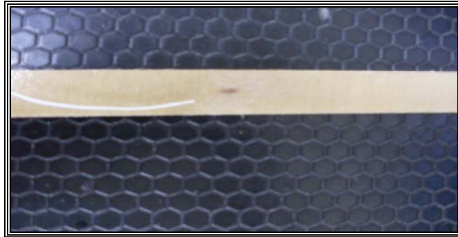
Şekil 3.20 Strain gauge yapıştırılmış ilmek çubuğu ( 90^\circ ) yönünde çekme numunesi
