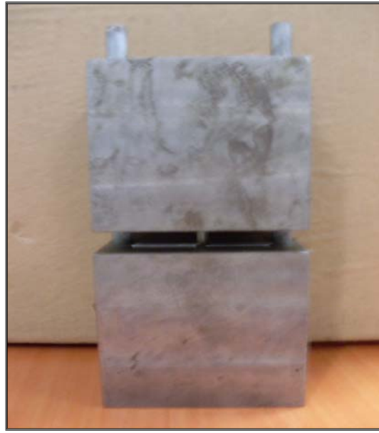
Şekil 3.24 (c) IITRI bası aparatına yerleştirilmiş bası numunesi (önden görünüş)
