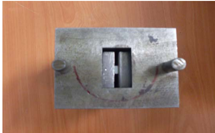
Şekil 3.24 (d) IITRI bası aparatına yerleştirilmiş bası numunesi (üstten görünüş)
