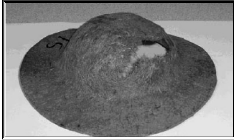
Şekil 2.1 Standart atmosfer koşullarında şekillendirilmiş Kenaf/PP kompozit
