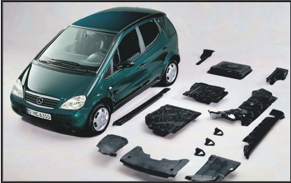
Şekil 1.27 Mercedes Benz A-sınıfında keten/PP iç kısım bileşenleri, cam lifli takviyeli plastik bileşenlerin yerini almıştır (Marsh, 2003)
