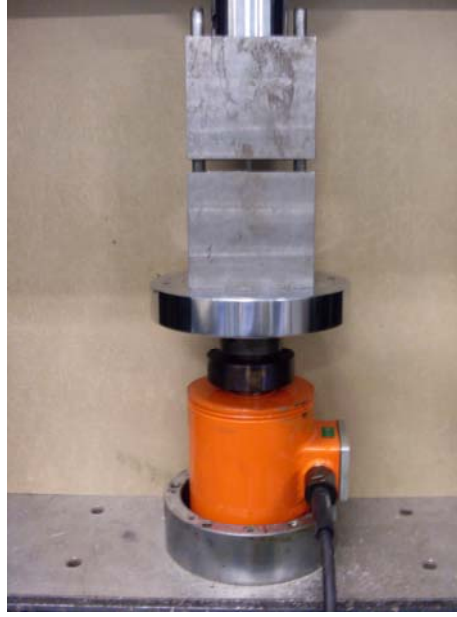
Şekil 3.25 Çekme cihazına yerleştirilmiş IITRI bası aparatı
